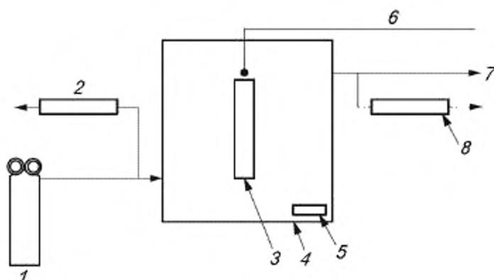
1 — источник подаваемого воздуха, содержащего целевой(ые) компонент(ы); 2 — пробоотборное устройство;
