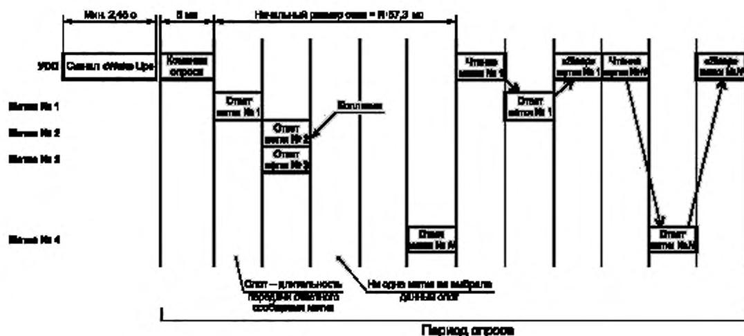
Рисунок 7 — Последовательность и синхронизация процесса опроса
