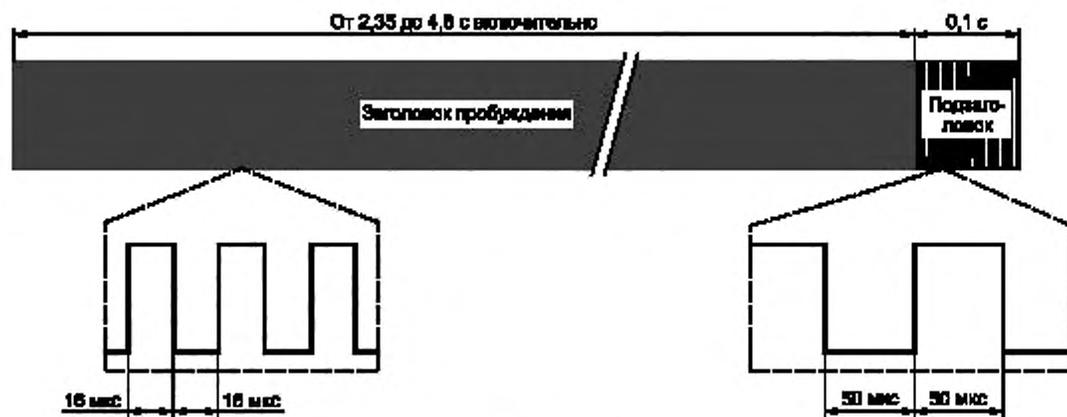
Рисунок 1 — Сигнал пробуждения «Wake Up»
