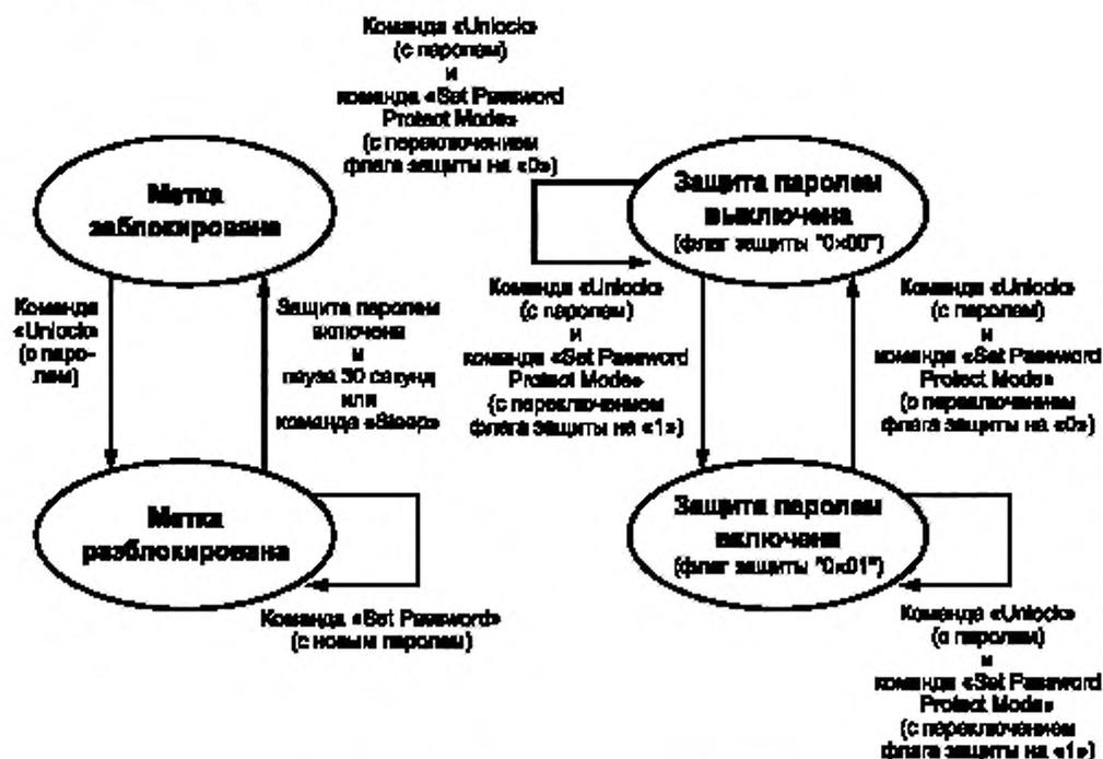
Рисунок 4 — Схема состояний механизма защиты
