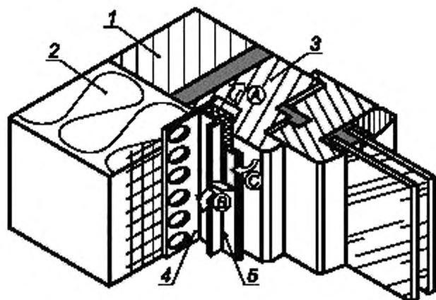
А — перед установкой профиля оконного примыкания с рядовой фасадной стеклосеткой удалить защитную ленту с клеящей поверхности уплотнительной ленты; В — удалить защитную ленту с клеящей поверхности вспомогательной пластиковой полоски и наклеить на нее полиэтиленовую пленку с целью защиты оконного блока на период монтажа системы; С — после монтажа системы удалить вспомогательную пластиковую полоску с полиэтиленовой пленкой
