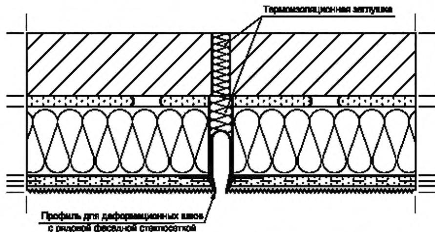
Рисунок Б.7 – Монтаж профиля для деформационных швов
