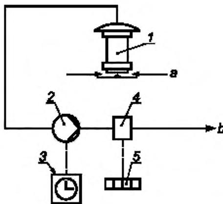
1 — устройство отбора проб; 2 — побудитель расхода воздуха; 3 — таймер; 4 — регулятор потока воздуха (с измерительной электроникой); 5 — счетчик истекшего времени; а — вход потока воздуха, б — линия сброса отработанного воздуха
