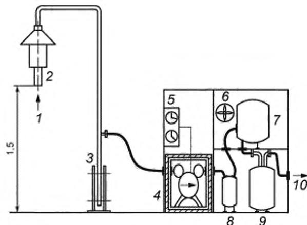
1 — вход потока воздуха; 2 — пробоотборная насадка; 3 — наклонный штатив; 4 — побудитель расхода и деа-звуконеприемник; 5 — таймер; 6 — вентилятор; 7 — воздухоохладитель; 8 — пылеуловитель; 9 — газовый счетчик; 10 — выход потока воздуха
