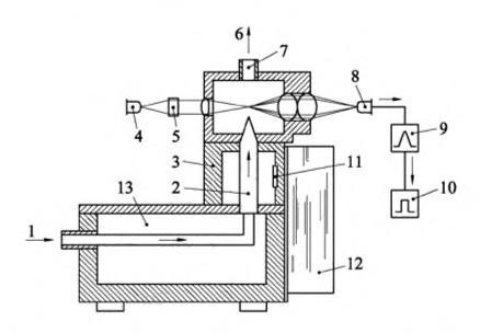
I — вход вэроз оля; 2 — конденсационная трубка; 3 — термоизоляция; 4 — лазерный диод; 5 — системалинз; 6 — вых од вэрозолей, 7 — форсунка; 8 — фотоприемник; 9 — аналоговый сигнал;
