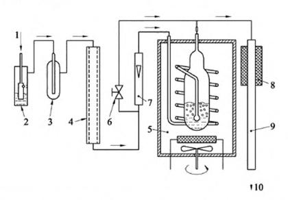
1 — подача азота; 2 — распылитель; 3 — сепаратор капель; 4 — диффузионный осущитель; 5 — термостат; 6 — байпасный клапан; 7 — расх одомер; 8 — подогреватель; 9 — конденсационная трубка; 10 — аэрозоль.
