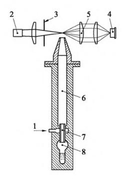
I — вх од аэрозоля; 2 — лазерный диод; 3 — отверстие; 4 — фотоприемник; 5 — световая ловушка; 6 — секция конденсации; 7 — смешивающая форсунка; 8 — ввод паров.
