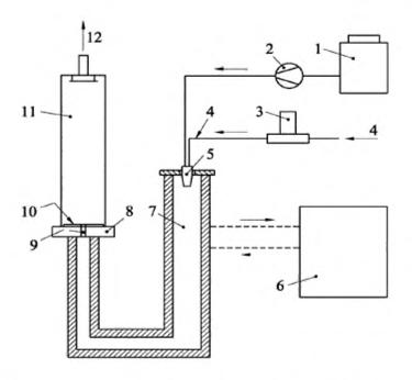
I-сосуд с DEHS; 2-насос; 3-расх одомер; 4-азот; 5-ультразвук овой распылитель; 6-термостат; 7-испарительная трубка с подогревом и из оляцией;
