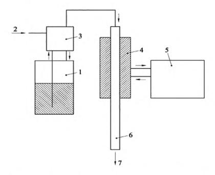
1- сосуд с жидк остью; 2- сжатый в оз дух; 3- распылитель; 4- секция испарения; 5- термостат; 6- секция конденсации; 7- аэроз оль.
