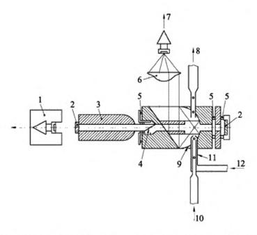
1—эталонный детектор; 2—зеркало лазера; 3—гелий-неоновый лазер; 4— брюстеровское окно; 5—уплотнительное кольцо; 6— асферические линзы, 7—фотоприемник; 8—выход аэрозоля; 9— параболическое зеркало; 10—вход аэрозоля; 11—насадка для аэрозоля; 12—защитный поток чистого воздуха.
