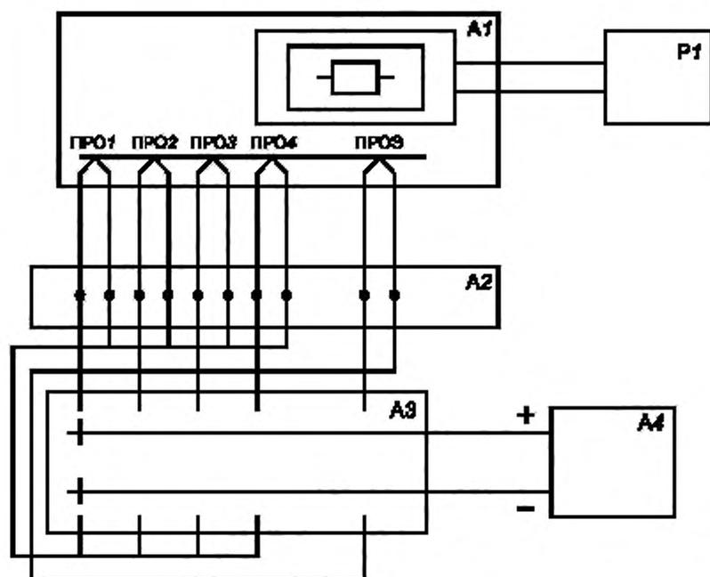
A1 — печь; A2 — термостат для свободных концов ПРО; A3 — переключатель; A4 — измерительный прибор постоянного тока;
