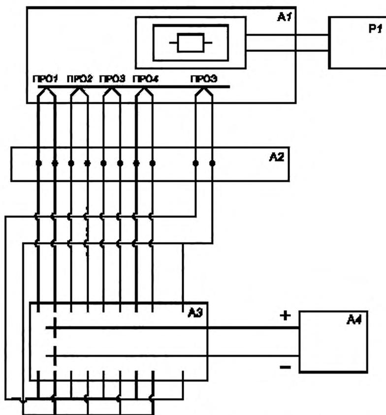
A1 — печь; A2 — термостат для свободных концов ПРО; A3 — переключатель; A4 — измерительный прибор постоянного тока;
