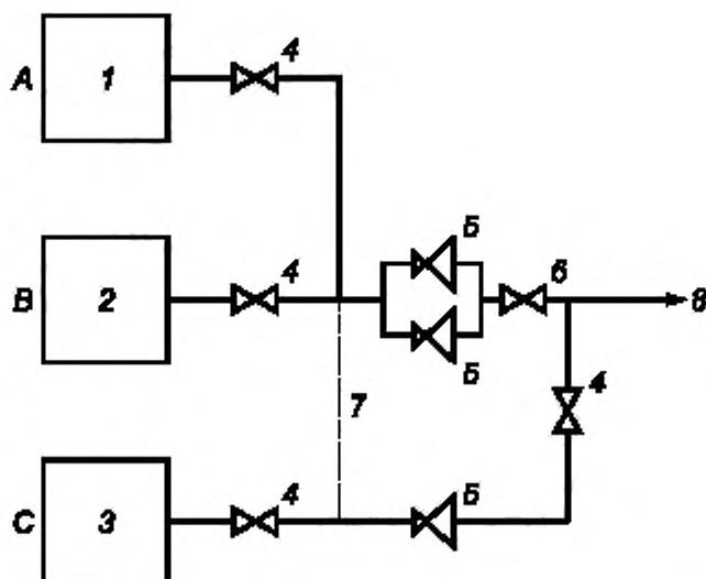
А — первичный источник подачи; В — вторичный источник подачи; С — резервный источник подачи; 1 — блок концентратора кислорода; 2 — баллоны высокого давления, содержащие кислород или воздух, обогащенный кислородом, или криогенный сосуд для жидкого кислорода; 3 — две группы баллонов высокого давления; 4 — запорный вентиль источника подачи; 5 — регулятор давления трубопровода; 6 — запорный вентиль системы подачи; 7 — необязательное соединение; 8 — к отводящей трубопроводной системе
