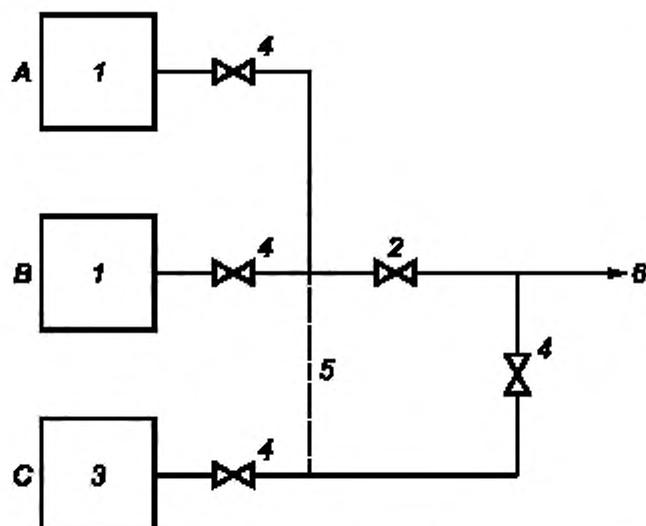
А — первичный источник подачи; В — вторичный источник подачи; С — резервный источник подачи; 1 — блок(и) концентратора кислорода; 2 — запорный вентиль системы подачи; 3 — две группы баллонов высокого давления; 4 — запорный вентиль источника подачи; 5 — необязательное соединение; 6 — к отводящей трубопроводной системе
