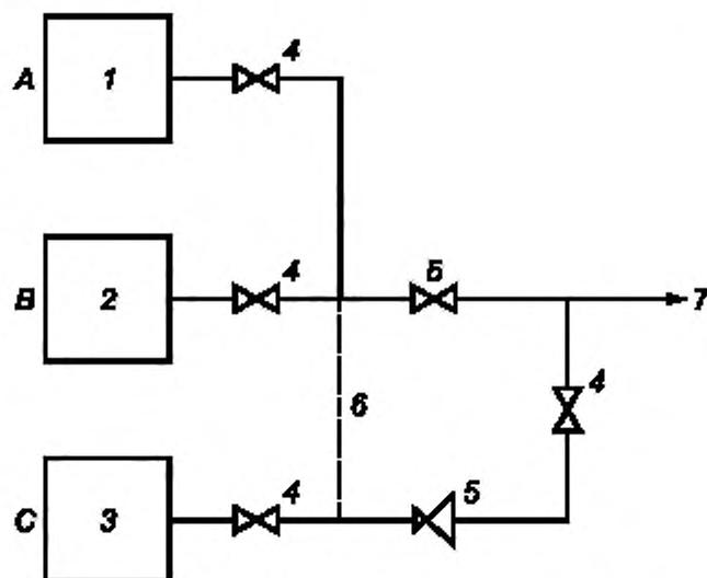
А — первичный источник подачи; В — вторичный источник подачи; С — резервный источник подачи; 1 — блок(и) концентратора кислорода; 2 — баллоны высокого давления, содержащие кислород или воздух, обогащенный кислородом, или криогенный сосуд для жидкого кислорода; 3 — две группы баллонов высокого давления; 4 — запорный вентиль источника подачи; 5 — запорный вентиль системы подачи; 6 — необязательное соединение; 7 — к распределительной системе
