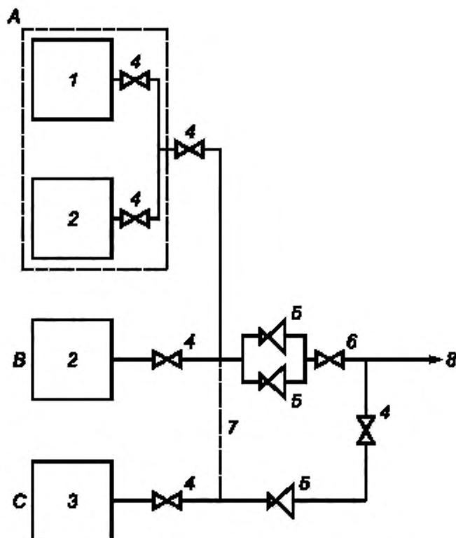
А — первичный источник подачи; В — вторичный источник подачи; С — резервный источник подачи; 1 — блок концентратора кислорода; 2 — баллоны высокого давления, содержащие кислород или воздух, обогащенный кислородом, или криогенный сосуд для жидкого кислорода; 3 — две группы баллонов высокого давления; 4 — запорно-выпускной вентиль источника подачи; 5 — регулятор давления трубопровода; 6 — запорный вентиль системы подачи; 7 — необязательное соединение; 8 — к отводящей трубопроводной системе
