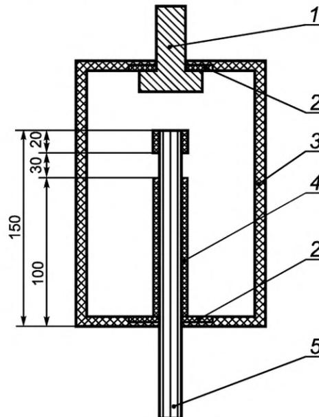
1 — стержень для захвата в зажиме разрывной машины; 2 — упорный подшипник; 3 — корпус устройства; 4 — изоляция;
