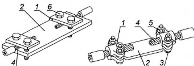
1 — прижимная пластина; 2 — неподвижная часть; 3 — шпилька с гайкой; 4 — проводник; 5 — гайка; 6 — винт
