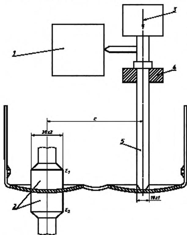
1 — измерительный прибор; 2 — кольцевая струбцина; 3 — направление и точка приложения силы (наибольшая — 5 Н); 4 — направляющее кольцо; 5 — давящий штырь;  $E_1$  и  $E_2$  — контактные поверхности
