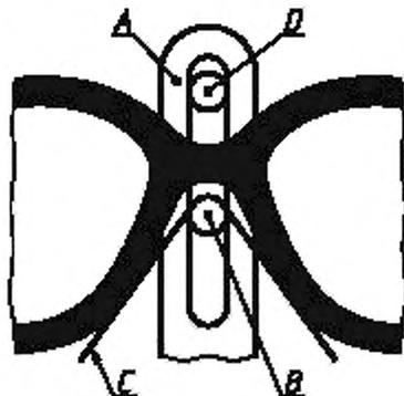
*A* — вертикальная стойка с щелью для регулирования по высоте; *B* — горизонтальный стержень, пропущенный через щель в вертикальной стойке *A* и закрепленный стопорным устройством для фиксации выбранной высоты; *C* — жесткая металлическая пластина, согнутая через горизонтальный стержень *B*, вращающаяся вокруг стержня при перемещении очковой оправы; *D* — ограничительный стержень, пропущенный через прорезь вертикальной стойки *A* и закрепленный стопорным устройством для фиксации выбранной высоты
