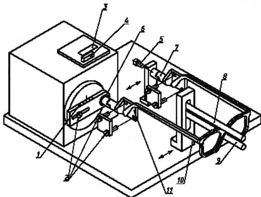
1 — шкала амплитуды смещения оправы; 2 — крепежные винты; 3 — окно счетчика; 4 — контрольный выключатель; 5 — фиксационный винт L; 6 — шариковый подшипник; 7 — универсальный шарнир; 8 — регулируемый ограничитель моста; 9 — регулируемый узел поддержки моста; 10 — регулируемая стойка для различных размеров очковых оправ; 11 — подвижный зажим
