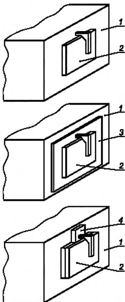
1 — монтажная поверхность; 2 — закрывающая пластина (накладка). 3 — опорная поверхность;
