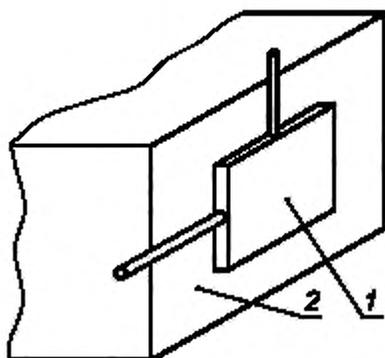
1 – закрывающая пластина (накладка); 2 – монтажная поверхность
