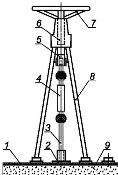
1 — облицовочная плитка; 2 — приклеиваемая стальная пластинка; 3 — стержень; 4 — динамометр 5 кН;
