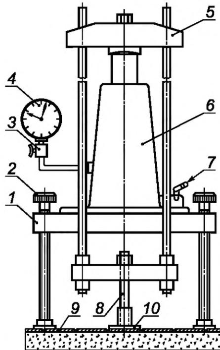
1 — основание (плита); 2 — регулируемые опоры; 3 — защитный клапан; 4 — манометр;
