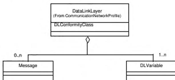
Рисунок 18 — Data Link layer профиля коммуникационной сети WorldFIP
