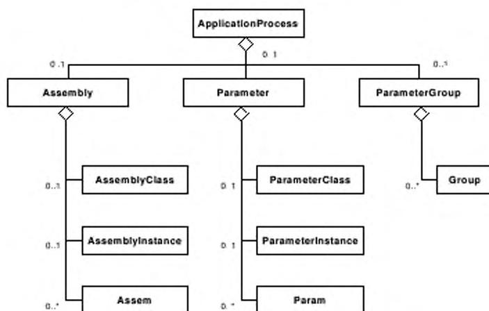
Рисунок 2 — Диаграмма класса ApplicationProcess профиля устройства ControlNet
