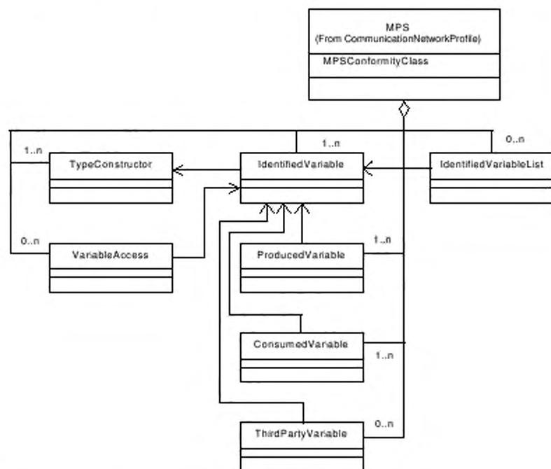
Рисунок 14 — Прикладной уровень MPS профиля коммуникационной сети WorldFIP
