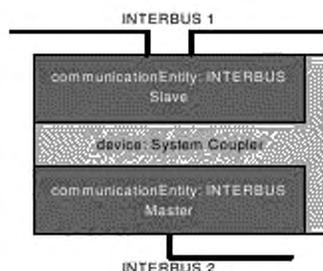
Рисунок 23 — Пример устройства с двумя объектами communicationEntity
