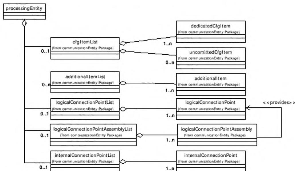
Рисунок 24 — Диаграмма класса `processingEntity` профиля устройства INTERBUS
