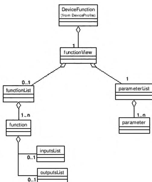
Рисунок 25 — Диаграмма класса DeviceFunction профиля устройства INTERBUS
