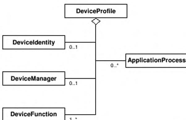
Рисунок 4 — Диаграмма классов профиля устройства PROFIBUS
