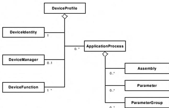
Рисунок 1 — Диаграмма классов профиля устройства ControlNet
