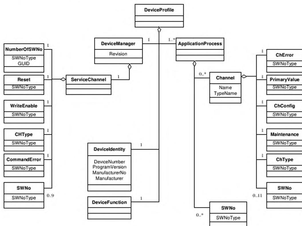
Рисунок 6 — Диаграмма классов профиля устройства P-NET
