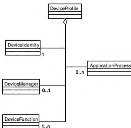
Рисунок 19 — Диаграмма класса профиля устройства INTERBUS
