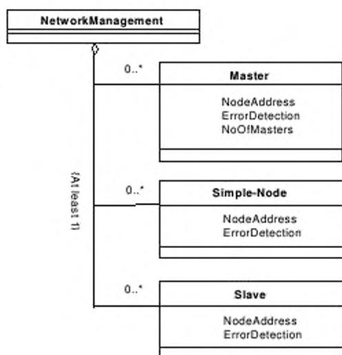
Рисунок 8 — Диаграмма класса **NetworkManagement** профиля коммуникационной сети P-NET
