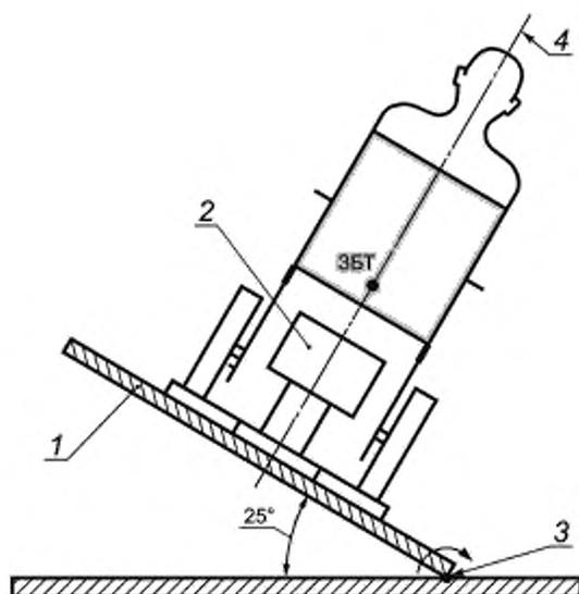
1 — наклонная испытательная платформа; 2 — устройство стыковочного крепления; 3 — ось наклона испытательной платформы; 4 — базовая плоскость кресла-коляски
