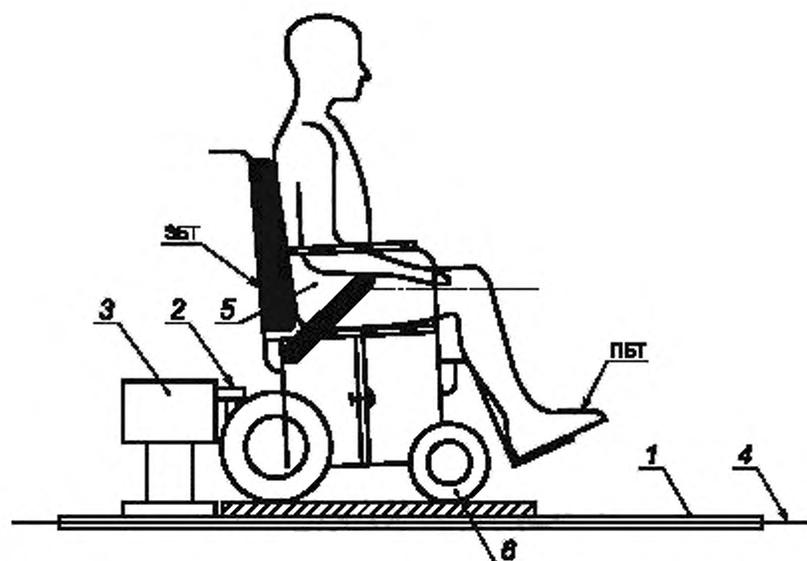
1 — наклонная испытательная платформа; 2 — переходник соединения кресла-коляски; 3 — устройство стыковочного крепления; 4 — ось наклона испытательной платформы; 5 — точка Р; 6 — правое переднее самоориентирующееся колесо
