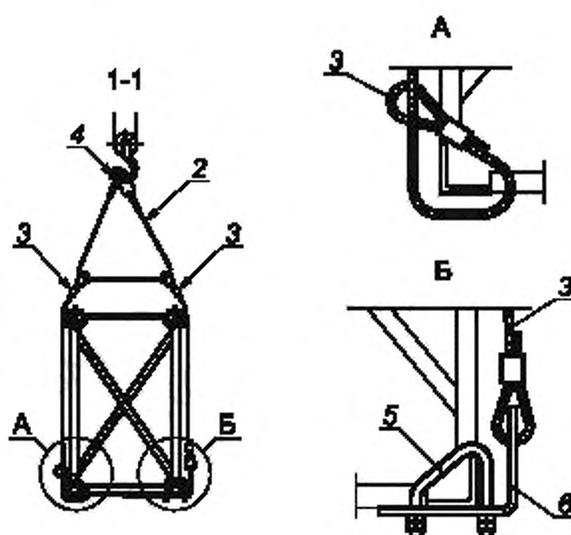
1 — ригель; 2 — двухветвевой строп с кольцом; 3 — двухпетлевой строп; 4 — мягкая проволока; 5 — болт-скоба диаметром 16 мм; 6 — планка;  $L_c$  — расстояние от края ригеля до места крепления тросовых строп
