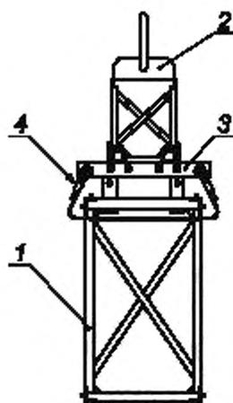
1 — ригель; 2 — траверса монтажная, 3 — устройство захватное; 4 — страховочный строп;  $L_c$  — расстояние от края ригеля до места крепления захватов траверсы
