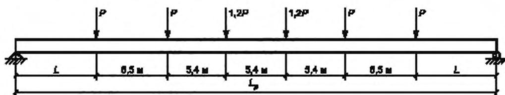
$P$  — испытательная нагрузка;  $L$  — длина;  $L_p$  — расчетная длина ригеля
