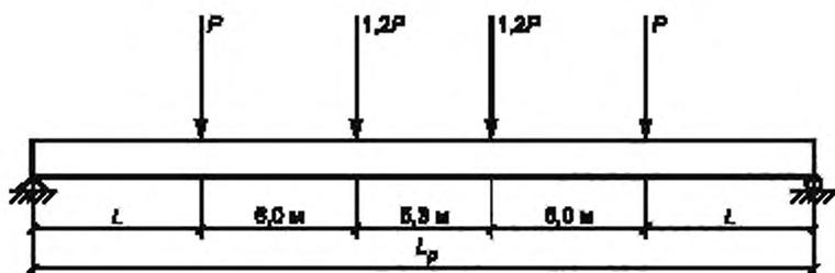
$P$  — испытательная нагрузка;  $L$  — длина;  $L_p$  — расчетная длина ригеля
