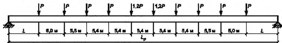
$P$  — испытательная нагрузка;  $L$  — длина;  $L_p$  — расчетная длина ригеля
