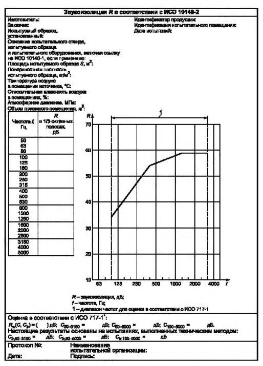
Рисунок В.1 — Пример формы для представления результатов испытаний
