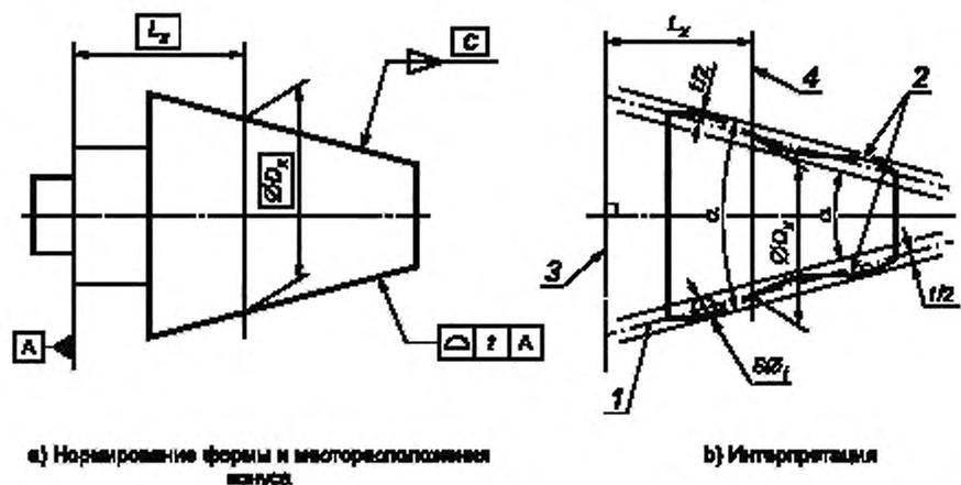
1 — поле допуска; 2 — выявленная поверхность, 3 — плоскость, присоединенная к выявленной «плоской» поверхности, соответствующей базе А; 4 — заданная плоскость на расстоянии  $L_x$  в миллиметрах, от присоединенной плоскости
