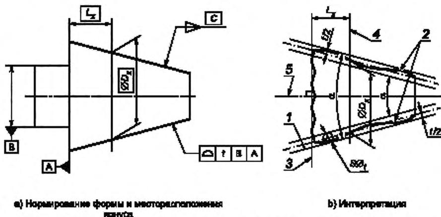
1 — поле допуска, 2 — выявленная поверхность; 3 — плоскость, присоединенная к выявленной «плоской» поверхности, соответствующей базе А; 4 — заданная плоскость на расстоянии  $L_x$  в миллиметрах, от присоединенной плоскости; 5 — ось присоединенного цилиндра
