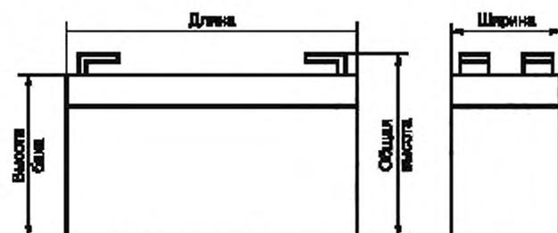
Рисунок 1 — Батареи призматического типа (Р-тип)
