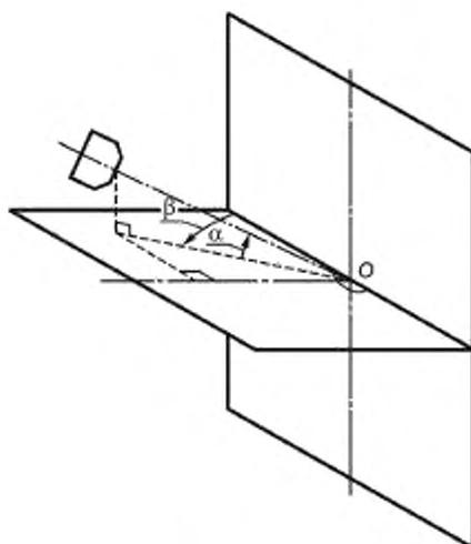
$\alpha = 0^\circ$  (ветры горизонтального направления),  $+ 30^\circ$  и  $- 30^\circ$ ;
