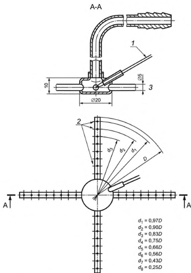
1 — термомпара; 2 — отверстия в каждом ответвлении:  $8 \times \varnothing 1$ ; 3 — пробоотборник
