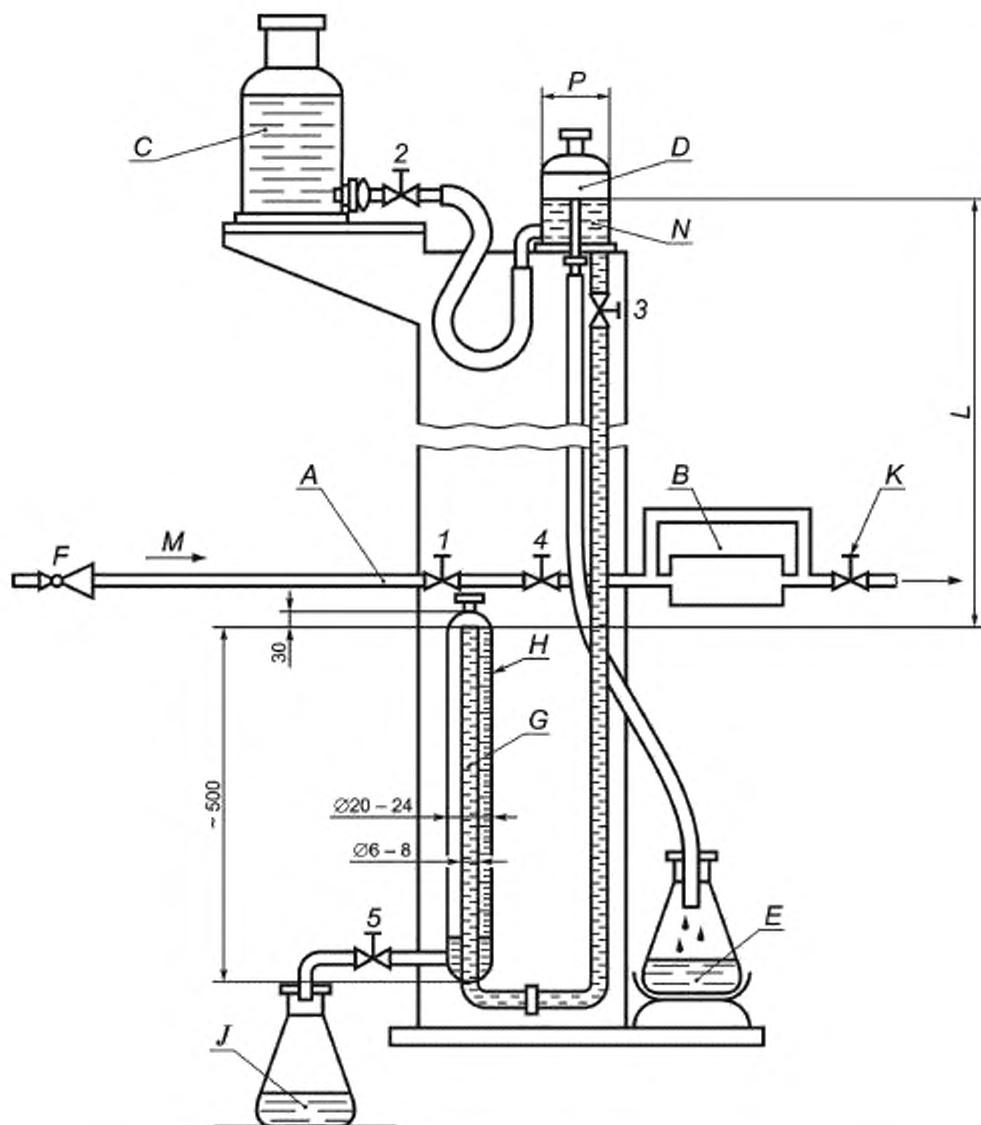
А — вход; В — испытуемый аппарат; С — резервуар с водой; D — сосуд с постоянным уровнем воды; E — перелив из сосуда с постоянным уровнем; F — регулятор давления; G — труба; H — бюретка; J — приемное устройство для перелива из бюретки; K — кран; L — высота воды, соответствующая испытательному давлению; M — сжатый воздух; N — трубки от 10 до 12 мм; P — внутренний диаметр 90 мм; с 1 по 5 — краны с ручным управлением
