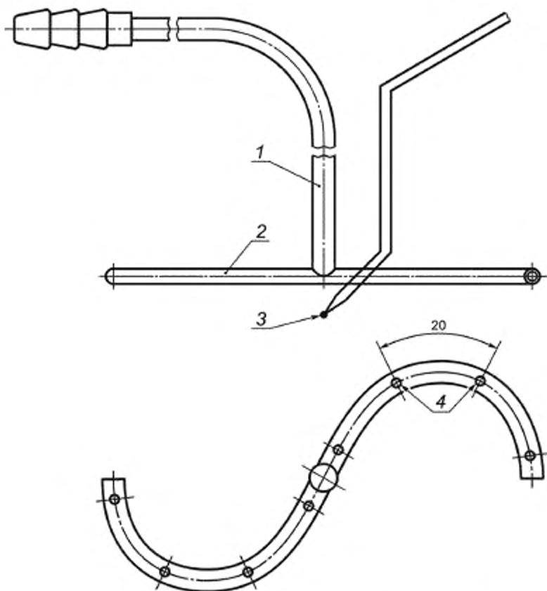
1 — трубка  $\varnothing 6$ ; 2 — трубка  $\varnothing 4/3$ ; 3 — термопара; 4 — отверстия:  $8 \times \varnothing 1$
