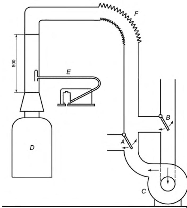
*A, B* — перелусковые клапаны для получения восходящей и обратной тяги; *C* — вентилятор; *D* — испытуемый аппарат; *E* — измерение скорости посредством трубки Пито; *F* — шланг
