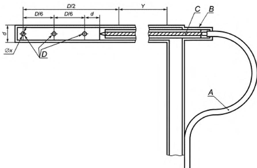
A – провода термпары; B – изолирующий цемент. C – двухканальная керамическая труба, D – три отверстия для отбора проб диаметром  $x$  мм
