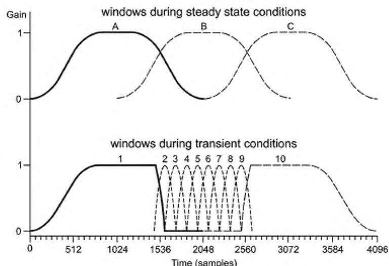
Рисунок В.4 — Пример переключения блоков при наличии резких изменений в сигнале
