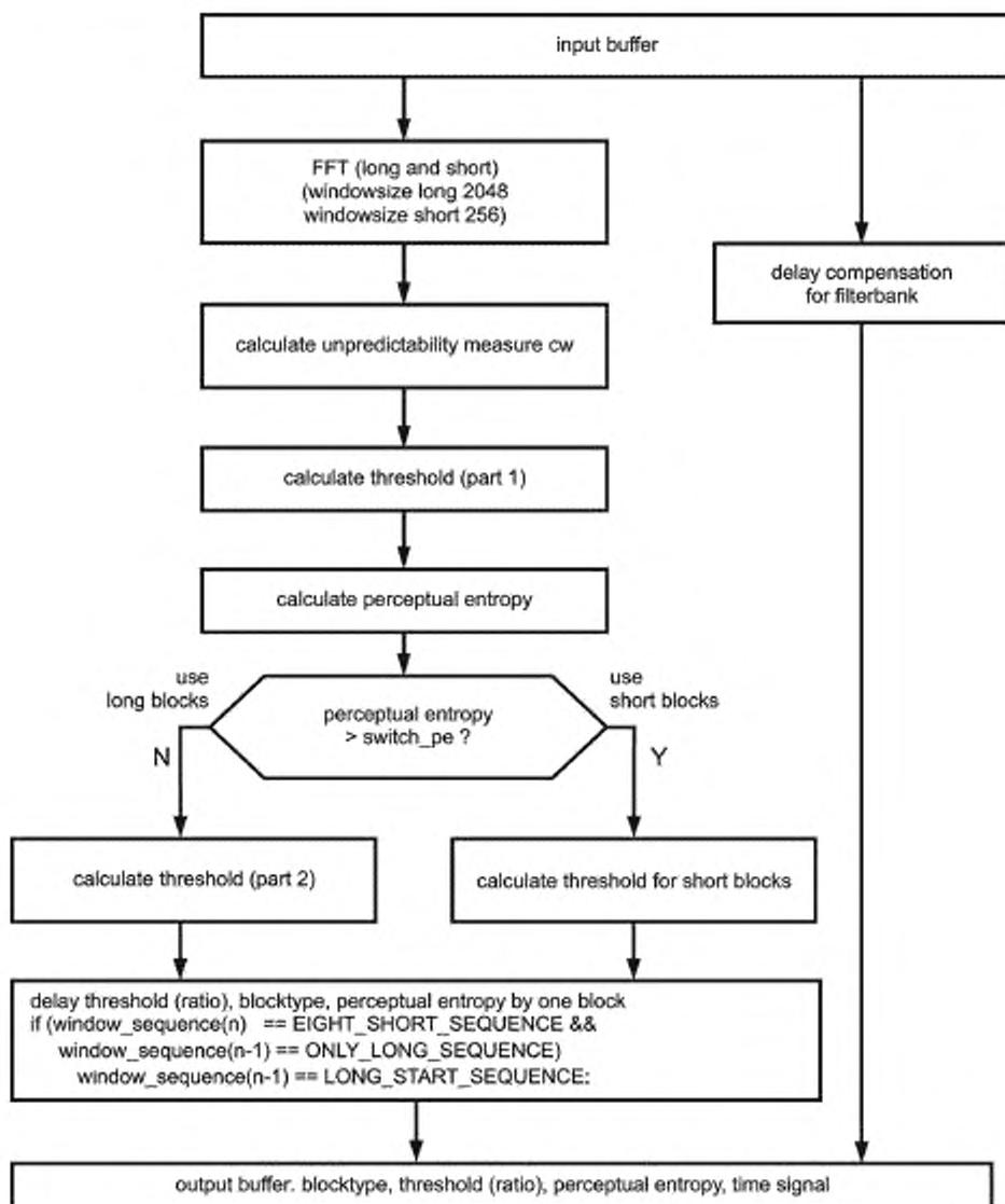
Рисунок В.1 — Блок-схема психоакустической модели
