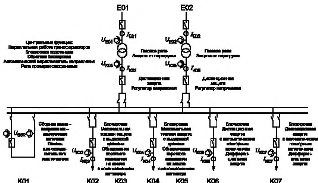
Рисунок 1.4 — Подстанция типа D2-1 с распределением функций
