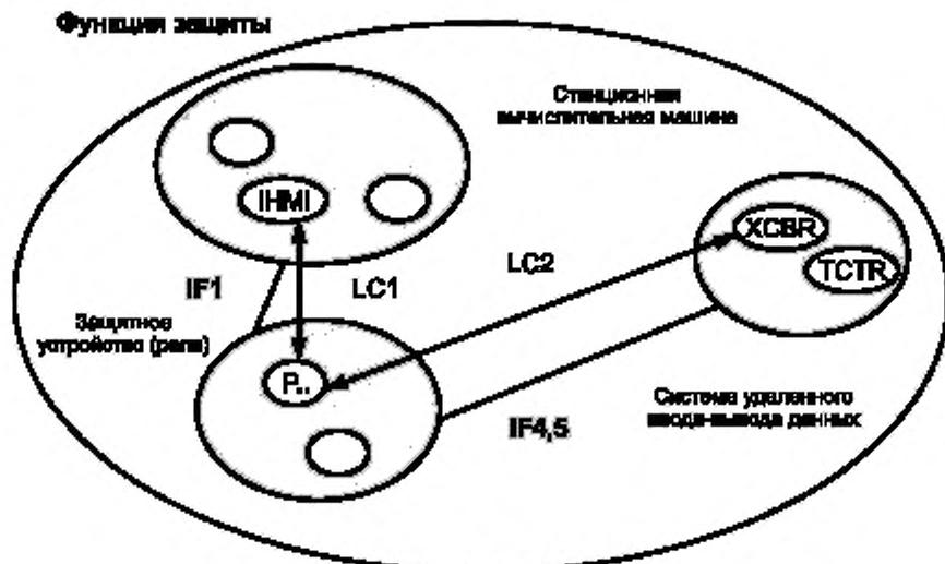
Рисунок 5 — Функция защиты, состоящая из трех LN
