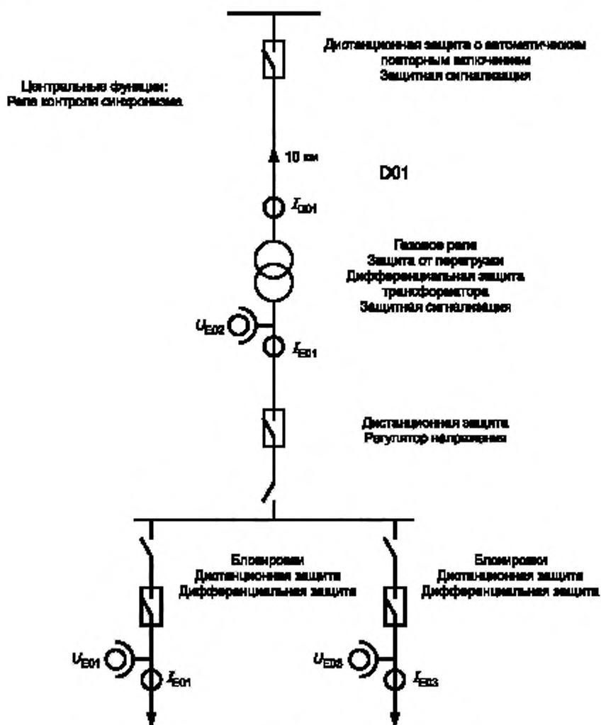
Рисунок I.3 — Подстанция типа T1-1 с распределением функций
