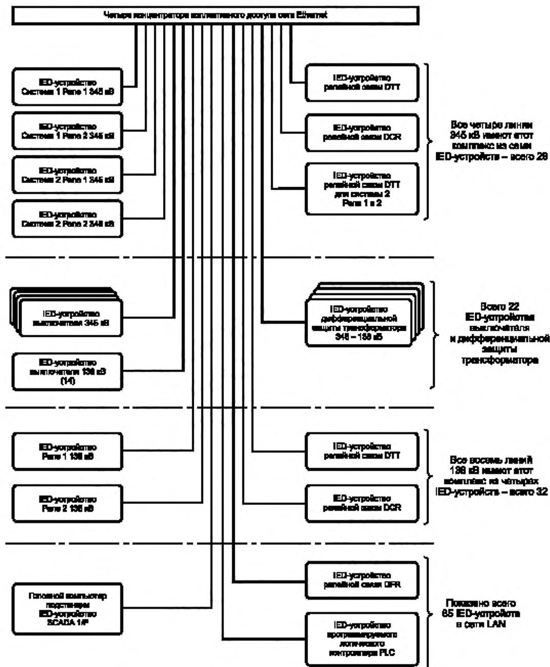
Рисунок 1.9 — Конфигурация сети Ethernet с концентратором коллективного доступа
