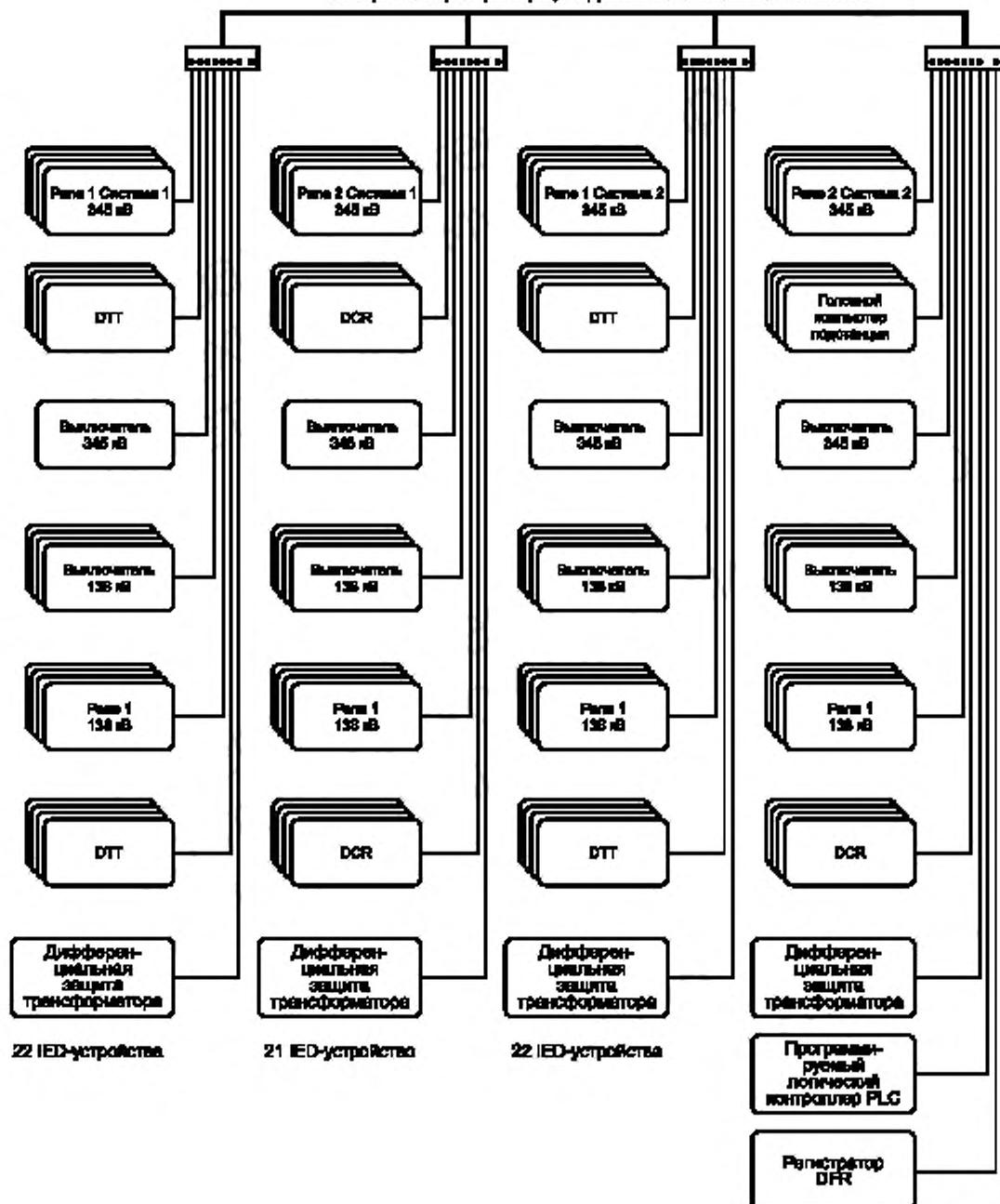
Рисунок 1.10 — Конфигурация сети Ethernet с коммутируемым концентратором
