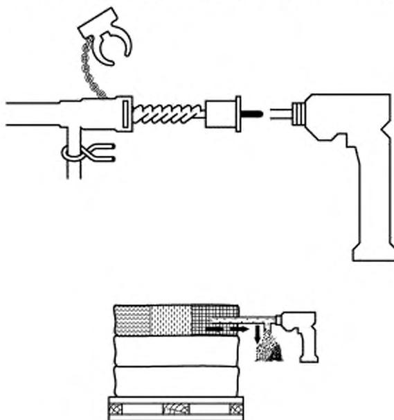
Рисунок В.11 — Винтовой пробоотборник Архимеда (портативный)
