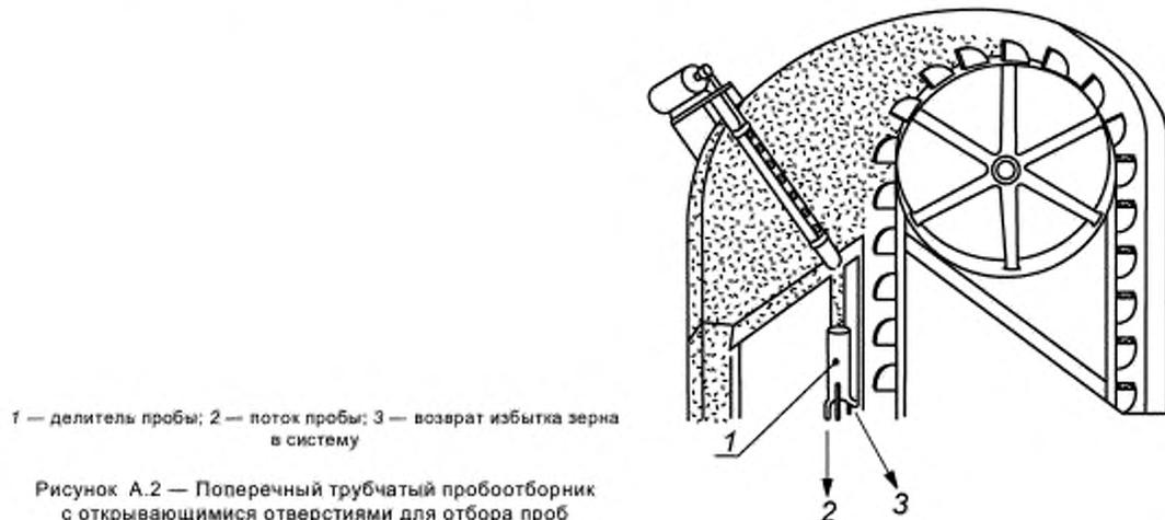
1 — делитель пробы; 2 — поток пробы; 3 — возврат избытка зерна в систему
