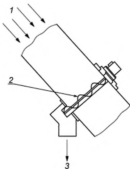
1 — поток зерна; 2 — шнек; 3 — поток пробы
