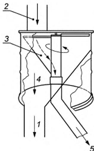
1 — поток зерна; 2 — вертикальная труба; 3 — вращающаяся воронка;
