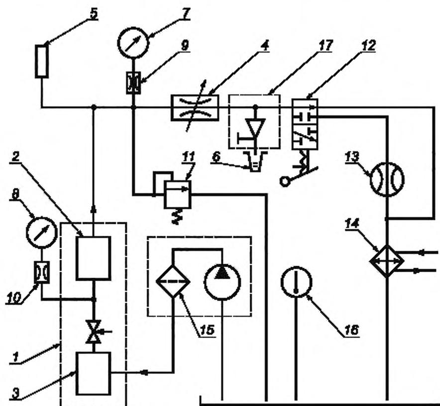
1 — насосная станция; 2 — насосная установка; 3 — бак; 4 — нагрузочный дроссель; 5 — тензодатчик; 6 — мерная емкость; 7 — манометр; 8 — мановакуумметр; 9, 10 — демпфер; 11 — предохранительный клапан; 12 — распределитель; 13 — расходомер; 14 — система охлаждения; 15 — система фильтрации; 16 — термометр; 17 — предохранительный клапан
