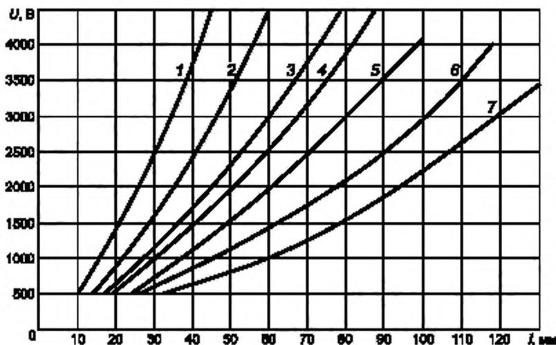
Кривая 1 — Минимальное расстояние по воздуху (воздушный зазор) в пространстве, закрытом от попадания влаги и грязи и полностью изолированном от влияния электрической дуги, т. е. от контакторов, разрывающих главные и вспомогательные цепи.
