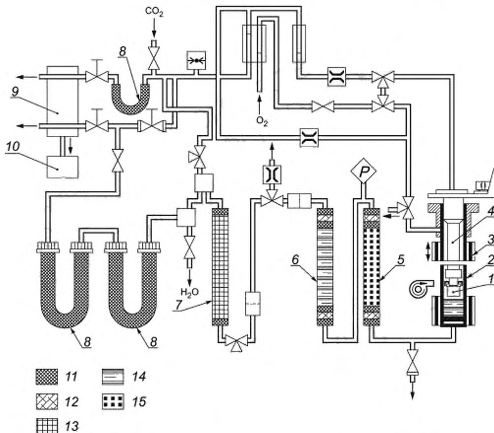
1 — тигель для анализа; 2 — колонка для сжигания; 3 — печь для сжигания (подвижная); 4 — держатель тигля; 5 — трубка для поглощения  $\text{SO}_2$ ; 6 — трубка дожигания; 7 — восстановительная колонка; 8 — сушильная трубка; 9 — детектор теплопроводности; 10 — интегратор; 11 — осушающее вещество; 12 — серебряная вата; 13 — медная проволока; 14 — медная проволока с платиновым катализатором; 15 — хромат свинца
