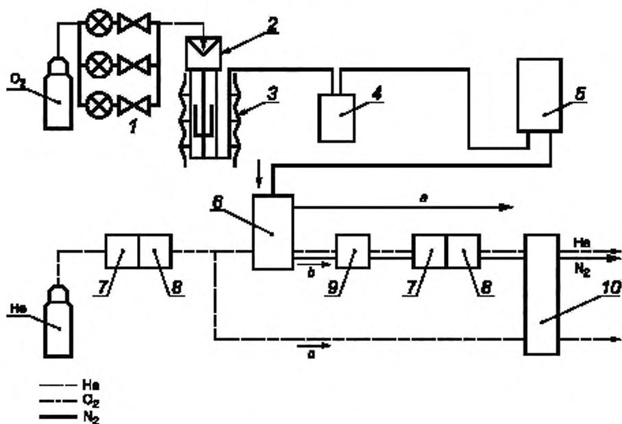
1 — регулятор потока кислорода; 2 — ввод пробы для анализа; 3 — электропечь сопротивления с тиглем; 4 — термоэлектрический куле, 5 — контейнер для смешивания (колонка с балластом), 6 — дозатор; 7 — гидроксид натрия на подложке; 8 — перхлорат магния, 9 — медный катализатор (восстанавливает NO<sub>x</sub> и O<sub>2</sub>); 10 — детектор теплопроводности, а — другие газообразные продукты горения; б — измерительный поток, с — контрольный поток
