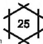
Для маркировки номинального тока и номинального напряжения могут использоваться только цифры, которые следует наносить на одном уровне и разделять их косой линией, или же значение номинального тока должно находиться над значением номинального напряжения, в этом случае они должны разделяться горизонтальной линией.
