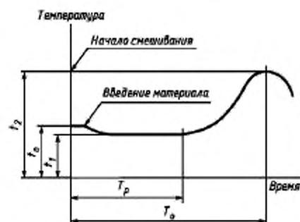
$t_0$  — начальная температура в момент введения материала;  $t_1$  — минимальная температура;  $t_2$  — максимальная (пиковая) температура;  $T_p$  — рабочее время;  $T_0$  — время отверждения
