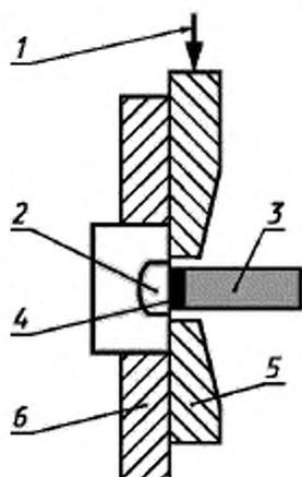
1 — нагрузка; 2 — субстрат — фрагмент зуба в монтажной пластмассе с открытой для испытания поверхностью эмали; 3 — испытуемый восстановительный материал; 4 — адгезив; 5 — нагружающая пластина в приспособлении для сдвига; 6 — кольцо в приспособлении для сдвига
