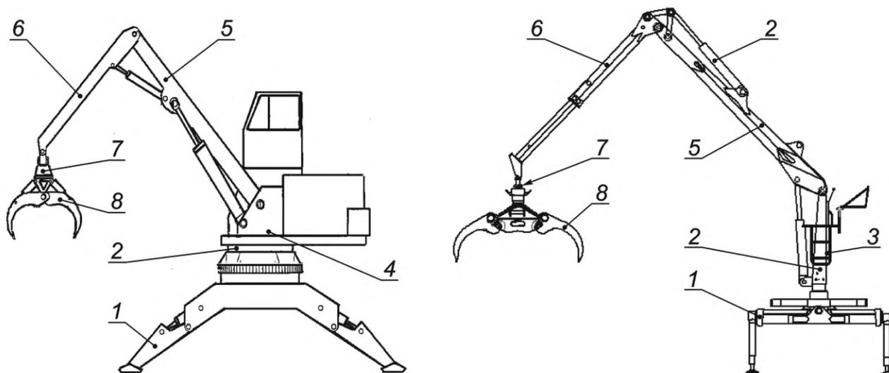
1 — аутригеры; 2 — опорно-поворотное устройство; 3 — поворотная колонна; 4 — поворотная платформа; 5 — стрела;
