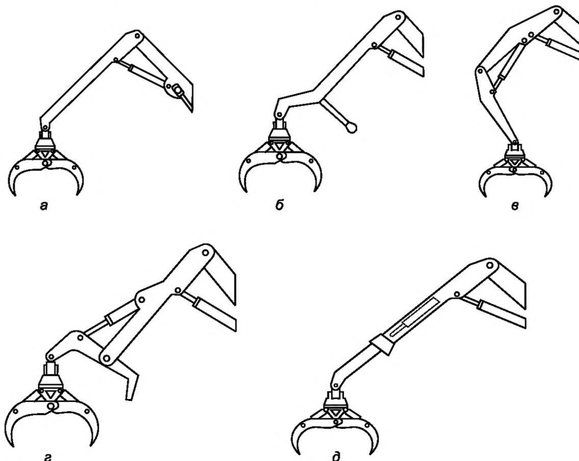
а — стреловое оборудование с прямой рукоятью; б — стреловое оборудование с неподвижным упором на рукояти; в — стреловое оборудование с двухзвенной рукоятью; г — стреловое оборудование с подвижным упором на рукояти; д — стреловое оборудование с телескопической рукоятью
