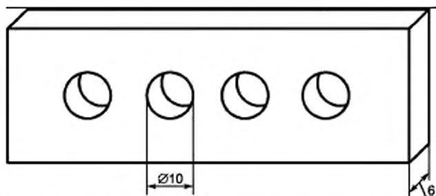
Рисунок 3 — Форма для образцов при испытании на текучесть
