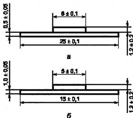
Рисунок 1 — Конфигурация образца для испытаний прочности связи керамики с металлом.
