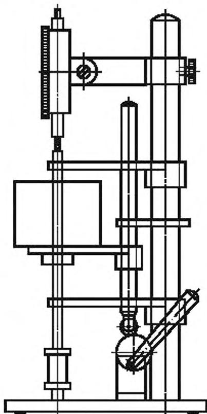
Рисунок 6 — Устройство для испытания на деформацию сжатия
