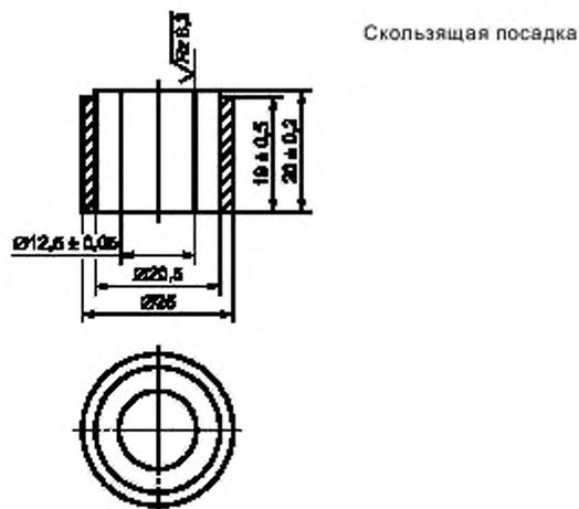
Рисунок 5 — Разъемная форма с фиксирующим кольцом
