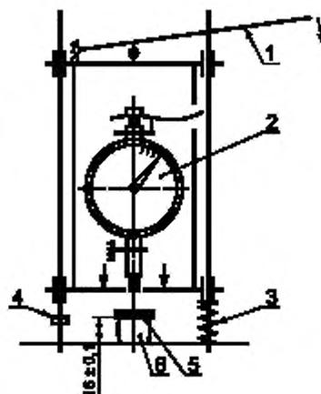
1 — рычаг для сжатия образца; 2 — цифровой индикатор; 3 — пружина; 4 — стопор; 5 — пластина;
