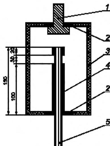
1 — стержень для захвата в зажиме разрывной машины; 2 — упорный подшипник; 3 — корпус устройства;
