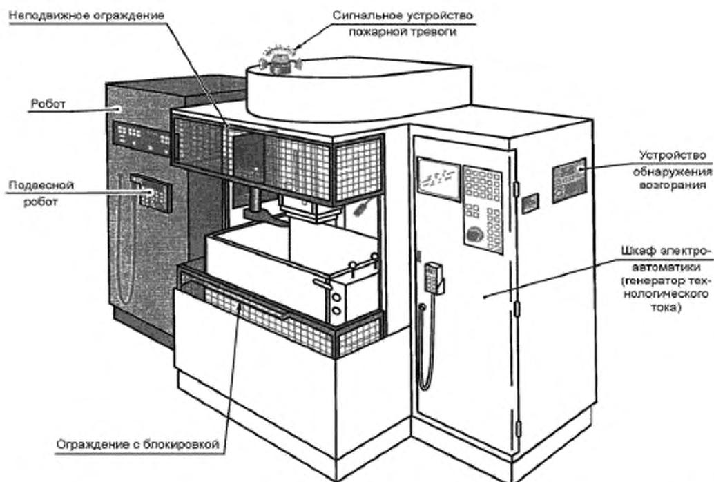
Рисунок А.8 — Электроэрозионный копировально-прошивочный станок с роботом
