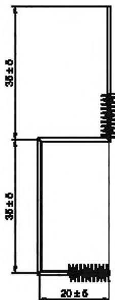
Рисунок 4 — Пример держателя для испытания на облуживание
