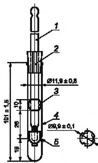
1 — термометр; 2 — прорезь в пробке для вентиляции; 3 — направляющая пробка для обеспечения необходимого зазора между термометром и пробиркой; 4 — пробирка из боросиликатного стекла; 5 — три равномерно расположенных углубления для удержания чашки
