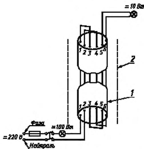
1 — образец кабеля; 2 — трехсторонняя металлическая камера
