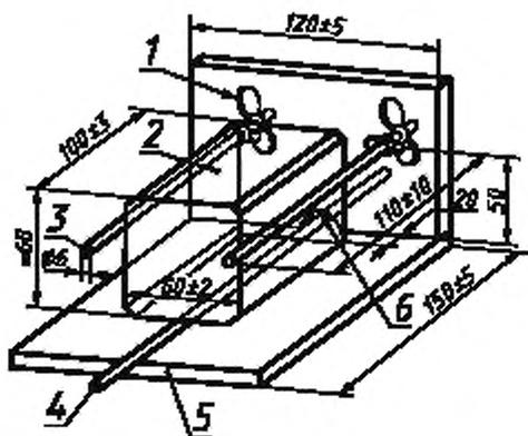
1 — фиксирующее устройство; 2 — блок; 3 — направляющий стержень; 4 — образец; 5 — стальная опорная плита;
