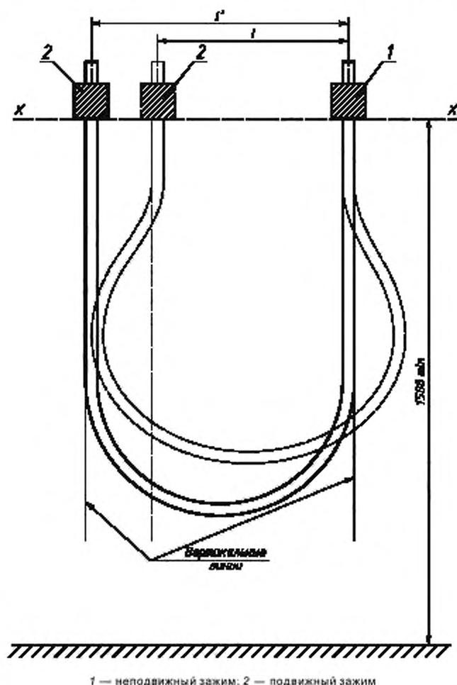
Рисунок 2 — Испытание на статическую гибкость
