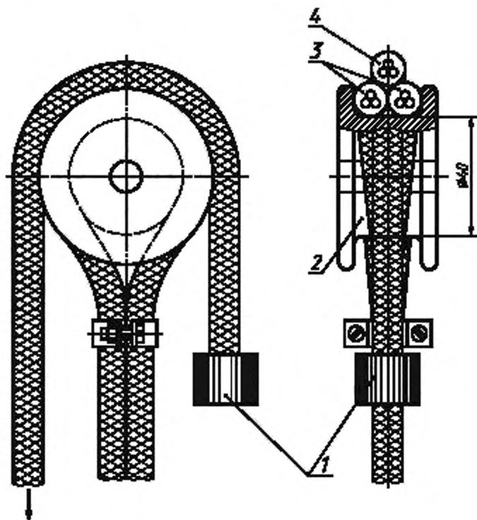
1 — груз; 2 — неподвижный ролик; 3 — закрепленный (неподвижный) образец;
