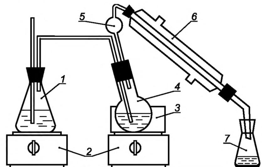
1 — колба коническая вместимостью 500 см<sup>3</sup> для получения водяного пара; 2 — плитка электрическая с регуляторами нагрева; 3 — баня с насыщенным раствором хлористого натрия; 4 — колба с исследуемым гидролизатом жира; 5 — каплеуловитель; 6 — холодильник; 7 — приемная колба для дистиллята (колба коническая вместимостью 250 см<sup>3</sup>)
