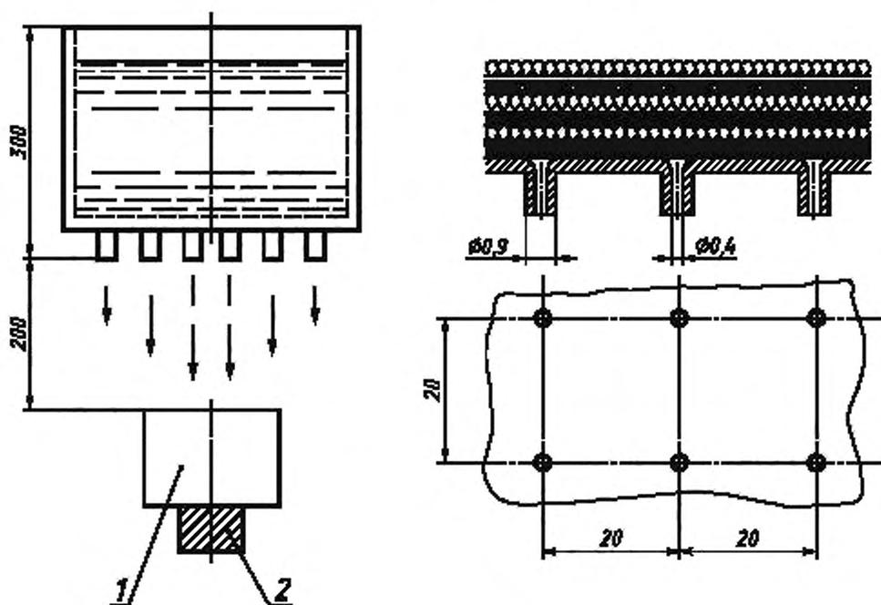
1 — испытуемый патрон; 2 — опорное устройство
