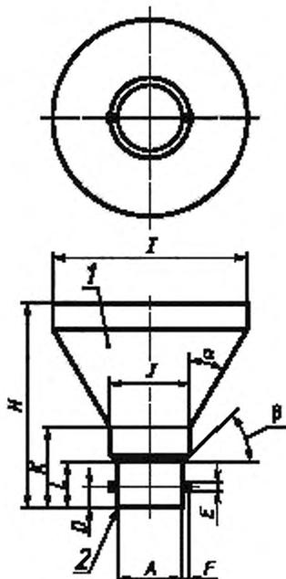
1 — изоляционный материал; 2 — кромки; слегка скруглены
