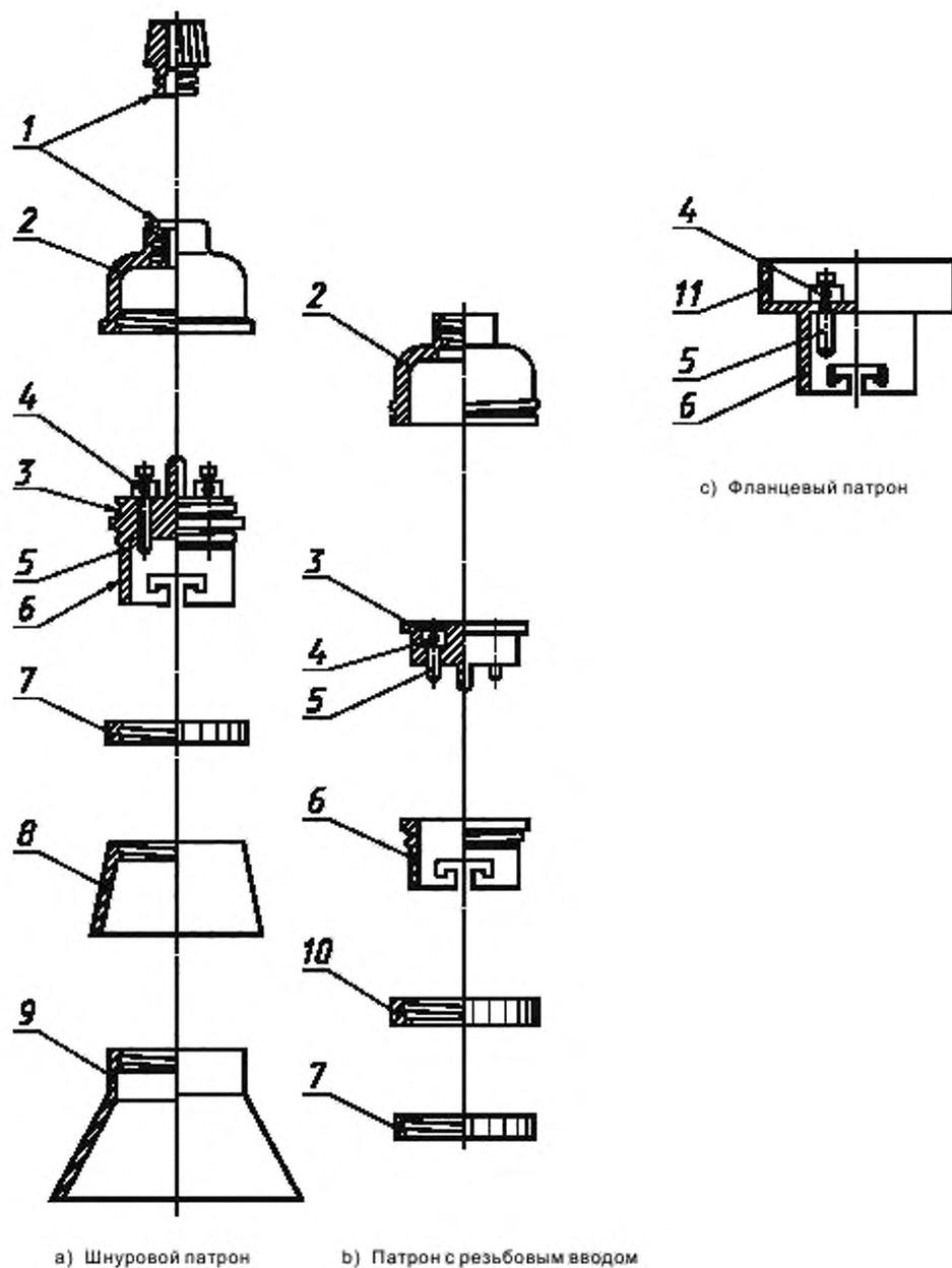
1 — крепление шнура; 2 — доньшко; 3 — корпус; 4 — контактный зажим; 5 — плунжерный контакт; 6 — гильза;
