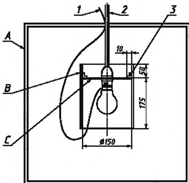
1 — провода термопары; 2 — сетевые провода; 3 — фланец
