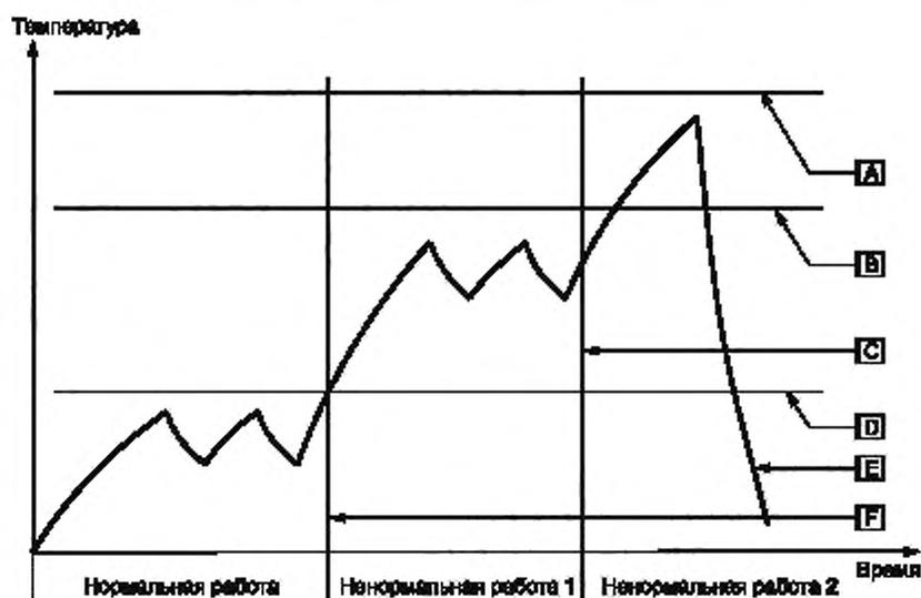
A — конечная опасная температура (ненормальное условие 2); B — промежуточная опасная температура (ненормальное условие 1); C — неисправность термовыключателя или ненормальное условие, при котором термовыключатель не реагирует; D — максимальная температура в ходе нормального использования; E — требуется замена управляющего устройства или части; F — состояние отказа
