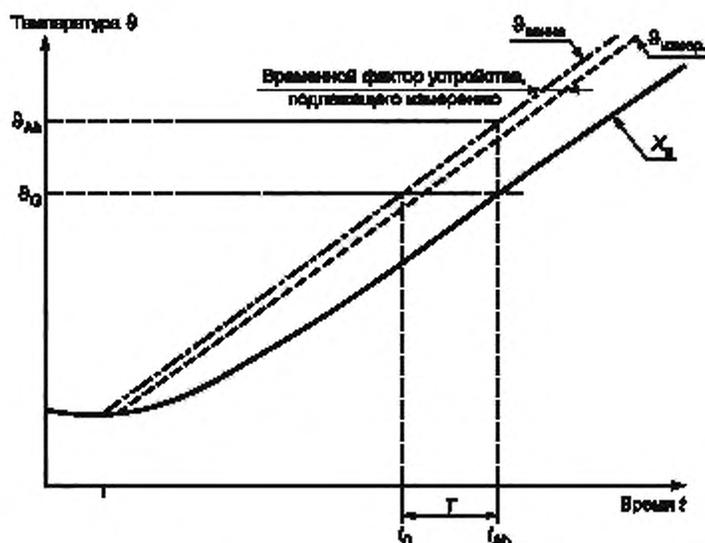
$\varphi_{\text{ванна}}$  — температура испытательной ванны;  $\varphi_{\text{измер.}}$  — измеренная температура ванны;  $X_{\text{д}}$  — выходной сигнал образца;
