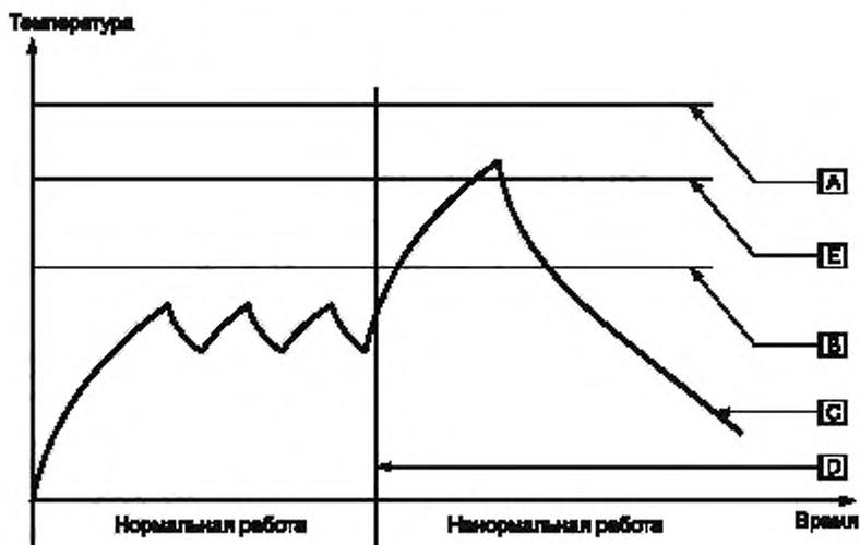
A — опасная температура; B — максимальная температура в ходе нормального использования;
