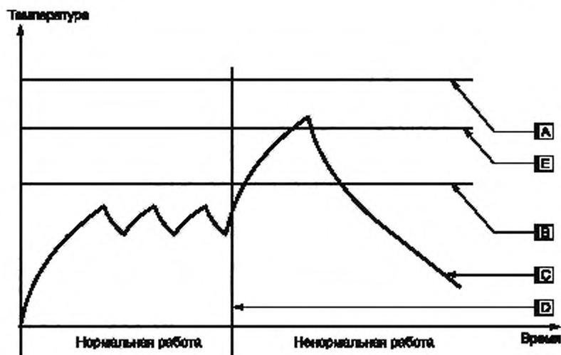
A — опасная температура; B — максимальная температура в ходе нормального использования; C — требуется замена управляющего устройства или части; D — состояние отказа; E — температура выключения устройством одиночного действия
