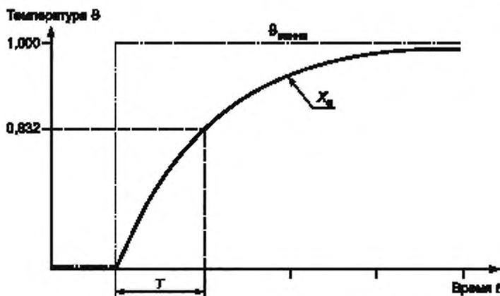
$\theta_{\text{ванна}}$  — температура испытательной ванны;  $X_d$  — выходной сигнал образца;  $T$  — временной фактор
