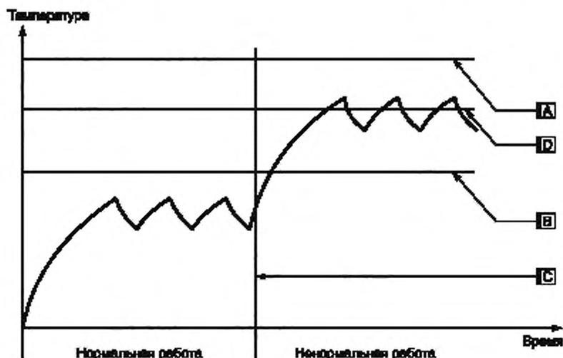
A — опасная температура; B — максимальная температура в ходе нормального использования; C — состояние отказа;
