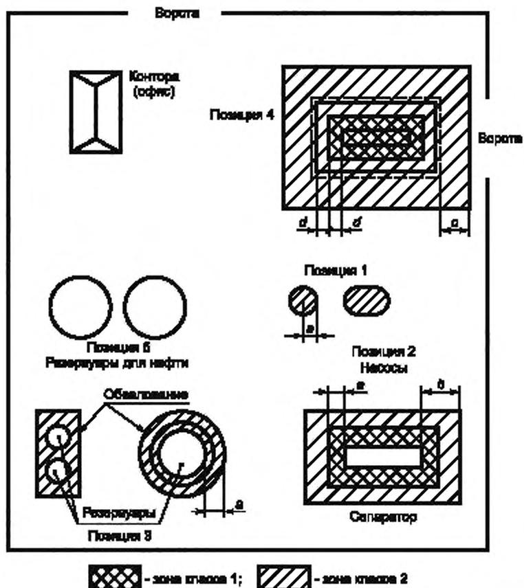
В данном примере показан один из способов применения примеров 1, 6, 8 и 9. В этом упрощенном примере три резервуара (облагодненные) для хранения бензина (поз. 3), пять насосов для жидкости (поз. 1), установленные вблизи друг от друга и один отдельный насос (поз. 1), одна установка для заправки автоцистерн (поз. 4), два резервуара для нефти (поз. 5) и один гравитационный сепаратор нефти/воды (поз. 2) расположены в пространстве резервуарного парка.
