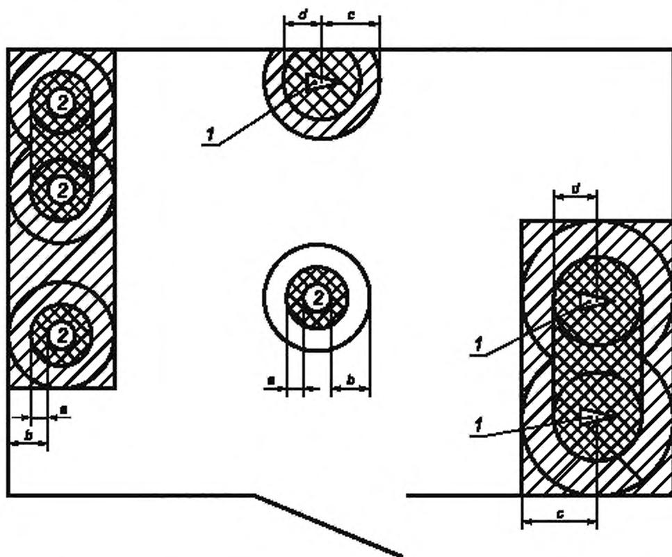
1 - насос для жидкостей; 2 - резервуар для смешивания красок;
