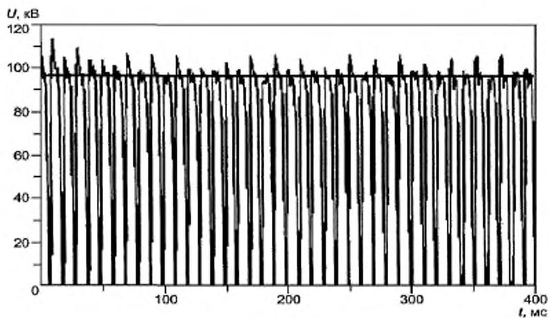
Рисунок В.1 – Пример выходного напряжения для двупульсного генератора
