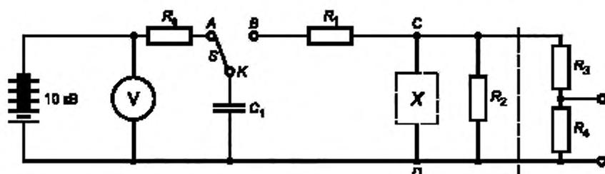
$C_1 = 1$  нФ;  $R_1 = 1$  кОм;  $R_2 = 4$  МОм;  $R_3 = 100$  МОм;  $R_4 = 0,1$  МОм;  $R_5^* = 15$  МОм (Резистор  $R_2$  используют, когда испытания по 13.2 выполняют на компоненте, включающем в себя только конденсатор).
