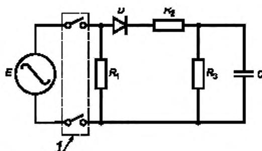
$$R_1 = \frac{E}{I} \quad (E \text{ — номинальное напряжение; } I \text{ — номинальный ток);$$
