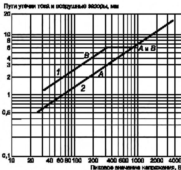
Примечание — B(1) — только для усиленной изоляции; A(2) — для основной и дополнительной изоляции, а также для испытаний в условиях неисправностей
