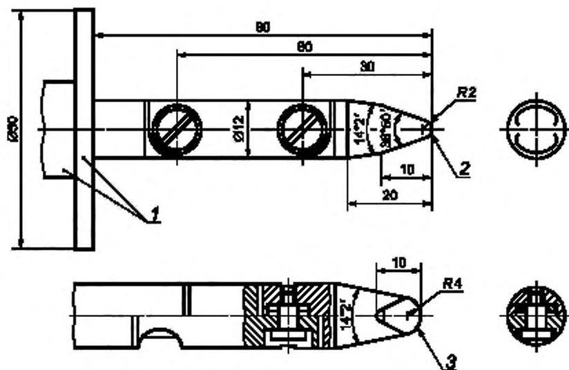
1 — изоляционный материал; 2 — цилиндрическая форма; 3 — сферическая форма
