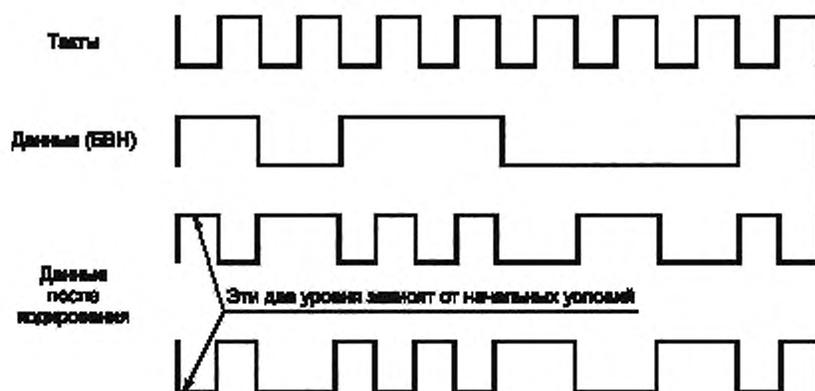
Рисунок 12 — Кодирование инверсным биполярным кодом БВН
