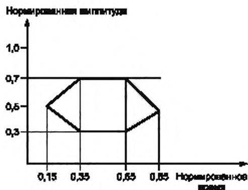
Рисунок 20 — Маска глазковой диаграммы передатчика при измерении джиттера
