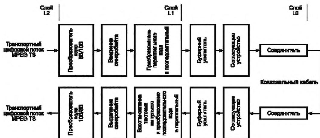
Рисунок 16 — Коаксиальная последовательная асинхронная линия передачи
