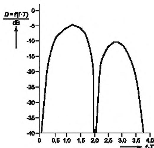
Рисунок 13 — Спектральные плотности инверсного биполярного кода БВН
