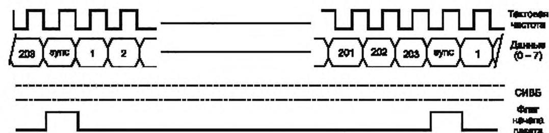
Рисунок 6 — Формат передачи пакетов с кодированием Рида-Соломона (204 байта)
