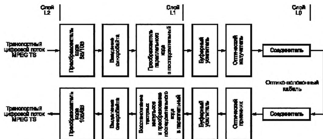
Рисунок 17 — Стекло-волоконная последовательная асинхронная линия передачи
