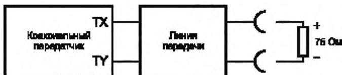
Рисунок 19 — Схема испытаний коаксиального передатчика
