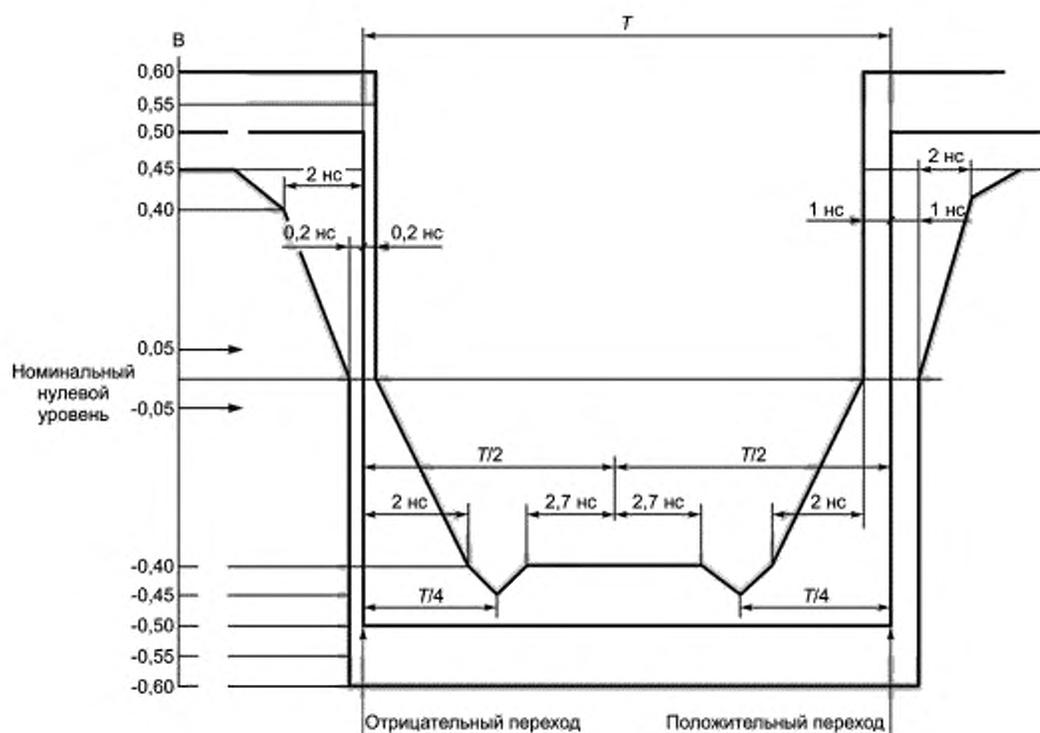
Рисунок 14 — Маска для импульса логического нуля
