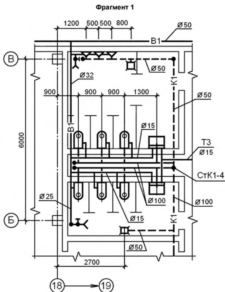
Рисунок А.3 — Пример выполнения фрагмента плана
