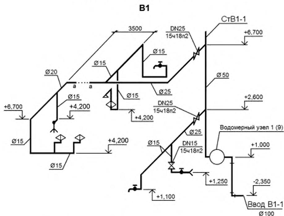
Рисунок Б.1 — Пример выполнения схемы системы водоснабжения
