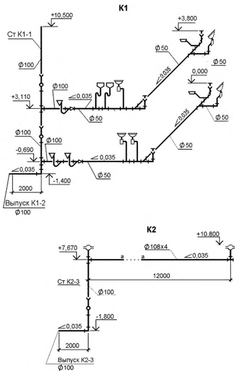
Рисунок Б.2 — Пример выполнения схем систем канализации
