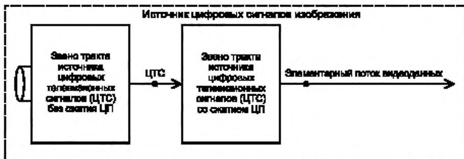
Рисунок 2 — Звенья тракта источника цифровых сигналов изображения
