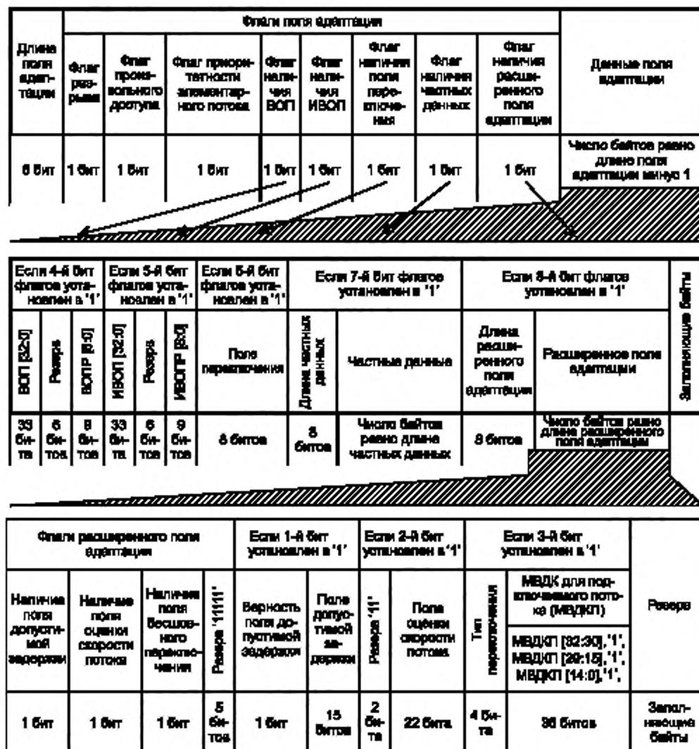
Рисунок 12 — Структура поля адаптации транспортного пакета
