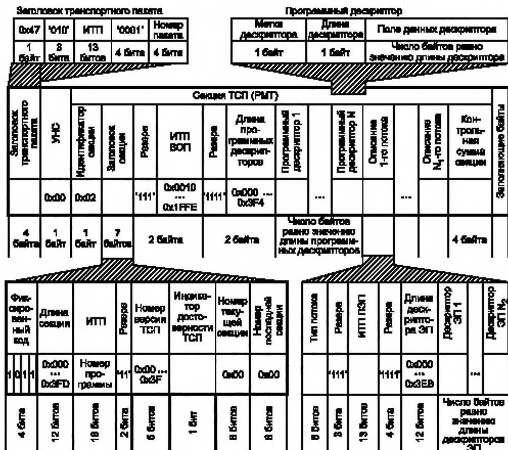
Рисунок 19 — Транспортный пакет с секцией ТСР (PMT)
