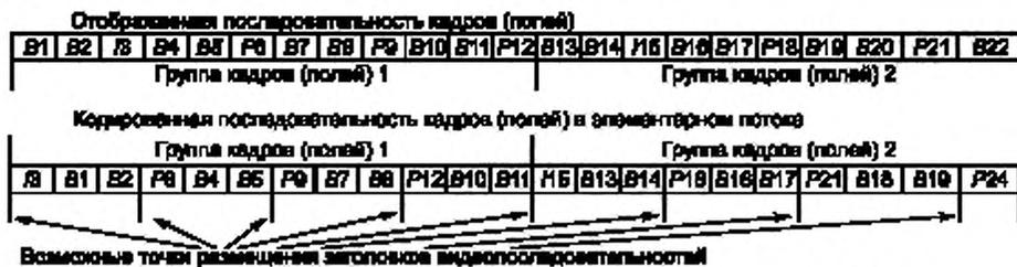
Рисунок А.16 — Отображаемая и кодируемая последовательность кадров
