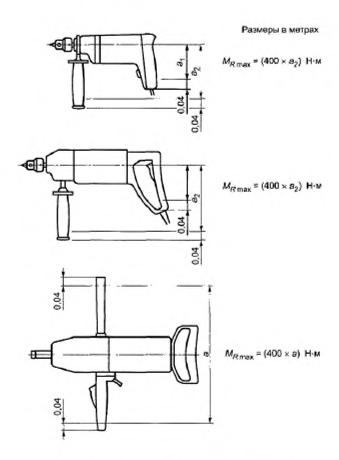
Рисунок 103 — Реактивный момент машин, удерживаемых двумя руками
