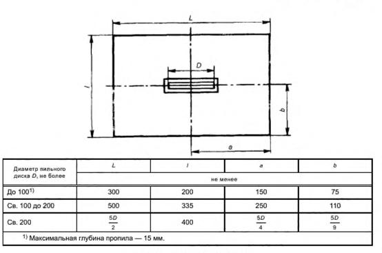
Рисунок 102 — Размеры пильного стола
