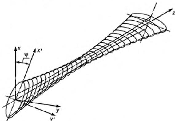
Рисунок 1 — Ориентация системы координат астигматического волнового фронта относительно системы механических осей
