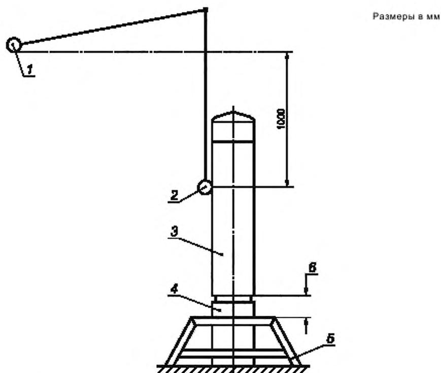
а — Схема для испытания ШРКП на сопротивление удару
