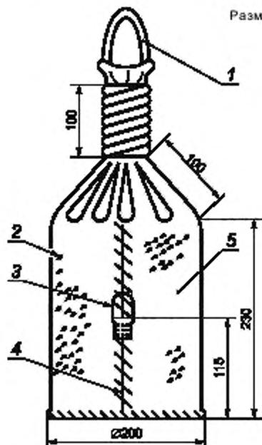
1 — петля для подвеса, 2 — песок с размером частиц от 0,5 до 0,8 мм; 3 — ушко, используемое для подъема мешочка и последующего его опускания; 4 — шов (только со стороны ушка, ударная сторона без шва); 5 — мешочек (материал — любой подходящий эластичный материал, который не растрескивается от удара)
