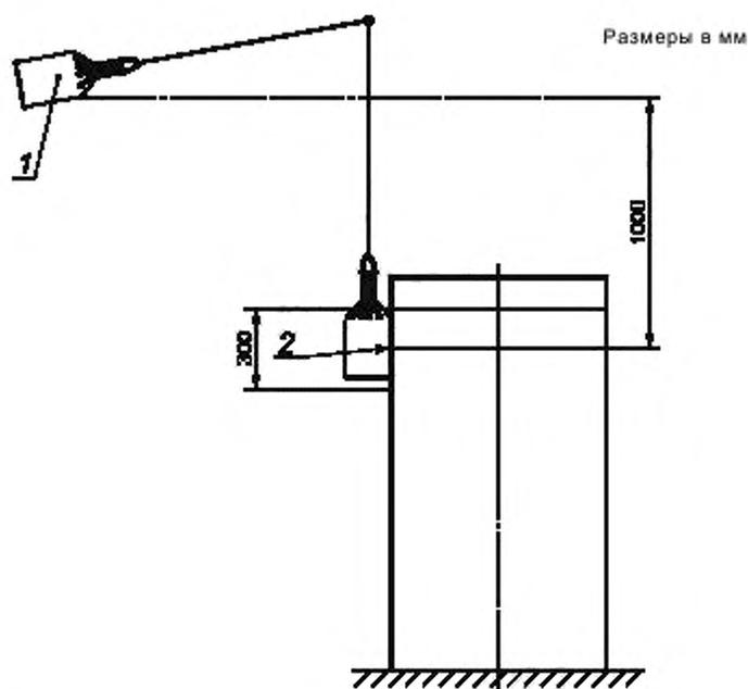
в — Схема испытания по проверке устойчивости ЩРКП — И к ударной нагрузке
