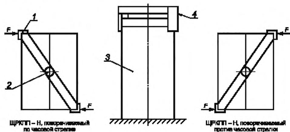
б — Схема испытания для проверки устойчивости ЩРКПП – Н к напряжению при кручении
