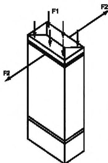
F1 — равномерно распределенная нагрузка 8500 Н/м<sup>2</sup>; F2 — растягивающие усилия 1200 Н
