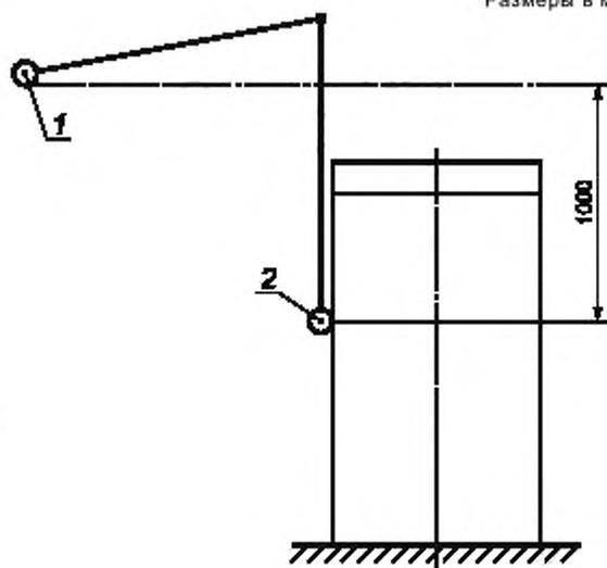
б — Схема для испытания ЩРКПП — И на сопротивление удару
