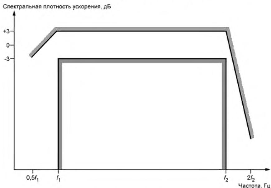
Рисунок 1 — Границы спектральной плотности ускорения (см. также 5.1.1)
