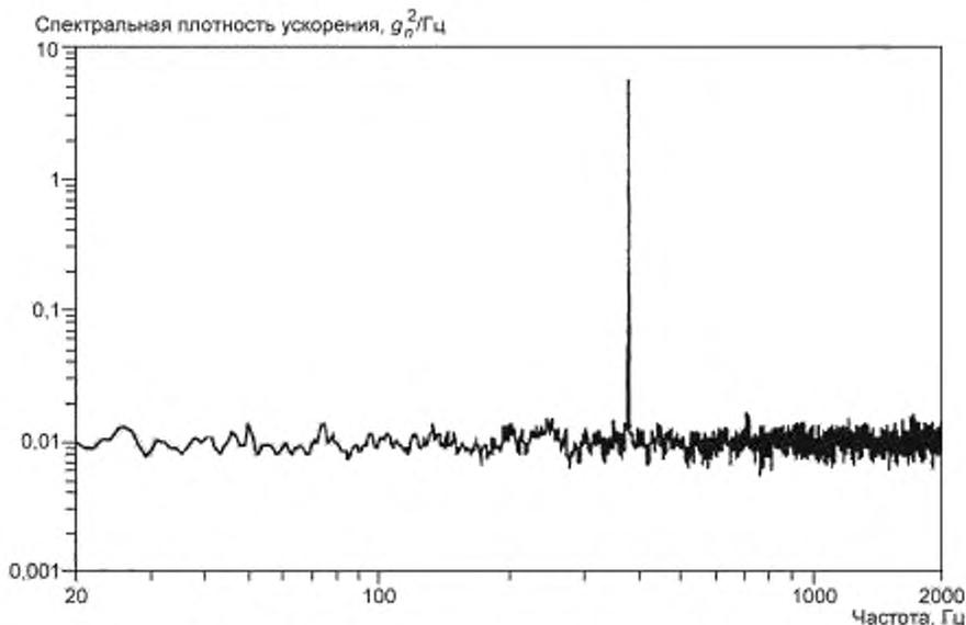
Рисунок А.2 — Гармонический сигнал на частоте 380 Гц
