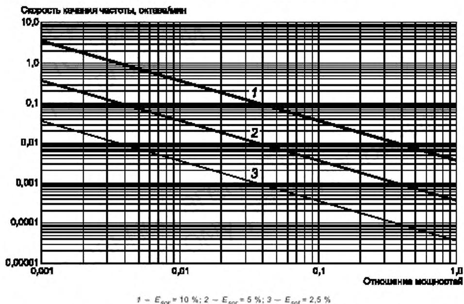
Рисунок 5 — Рекомендуемая скорость качания частоты в зависимости от отношения мощностей для разных значений  $E_{tot}$
