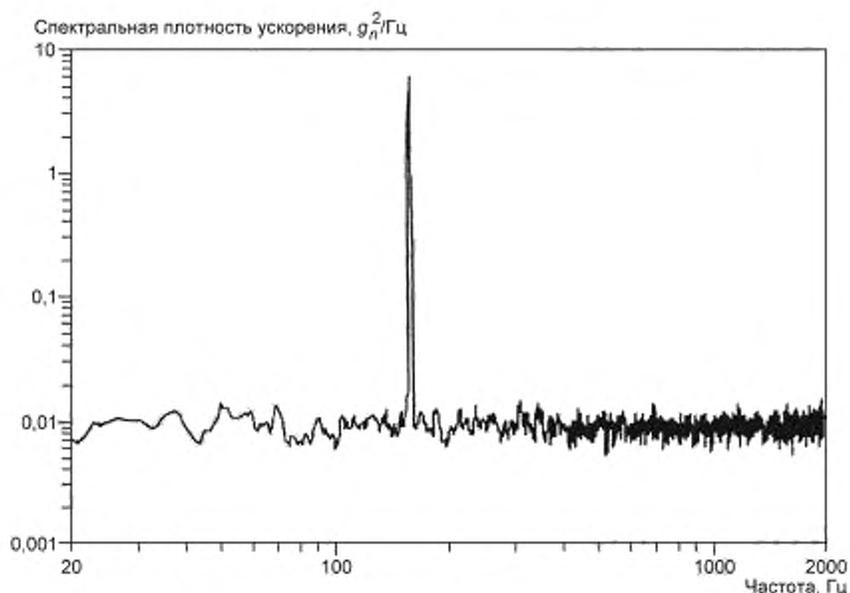
Рисунок А.1 — Гармонический сигнал на частоте 160 Гц
